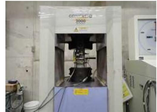
コア供試体の一軸圧縮試験
