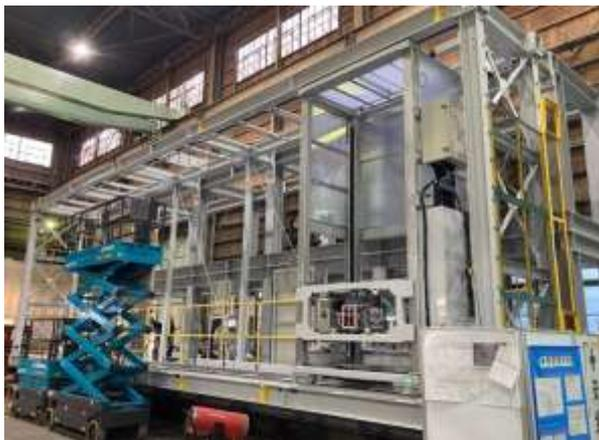
アンカー削孔装置フレーム
