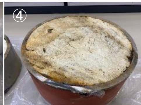
隙間の確認状況（4サンプルとも同様）
