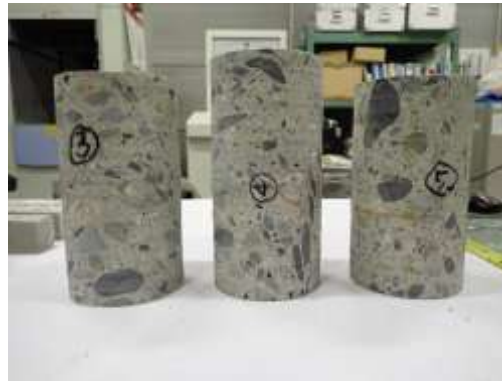
採取されたコンクリートコア
