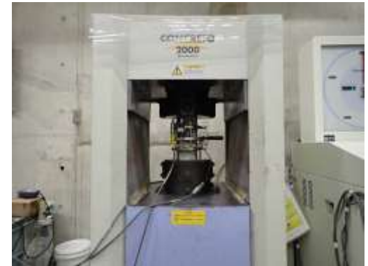
コア供試体の一軸圧縮試験
