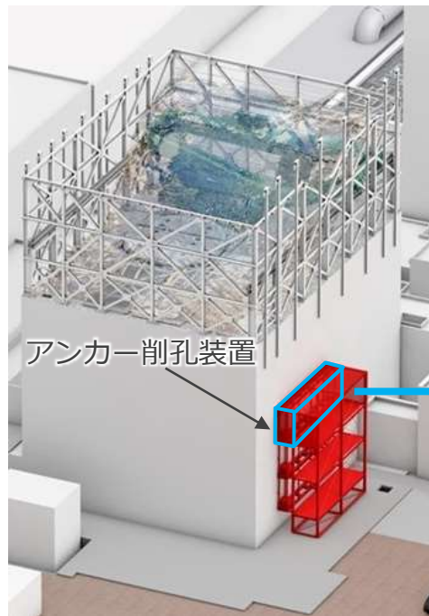
アンカー設置作業イメージ
