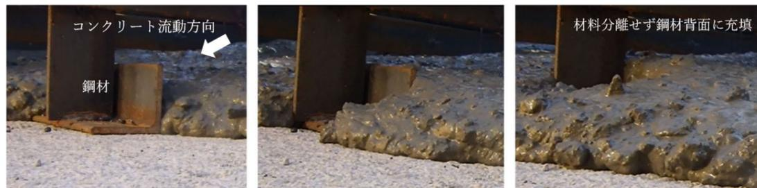
図6. モックアップA内のコンクリート流動・充填状況（撮影動画より抜き取り）
