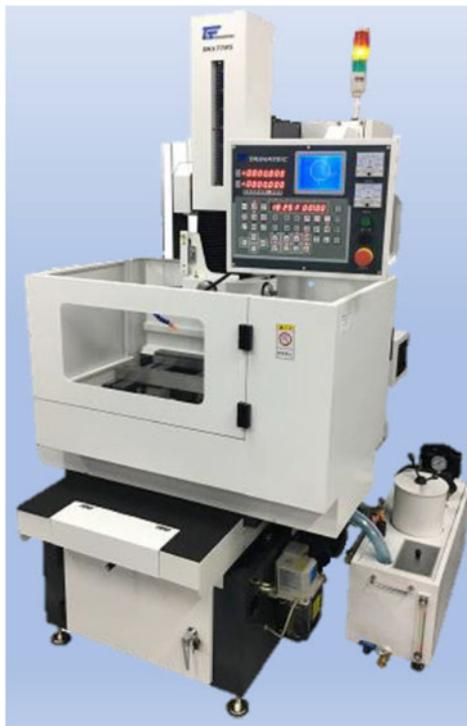
図1 ワイヤ放電加工機の外観
