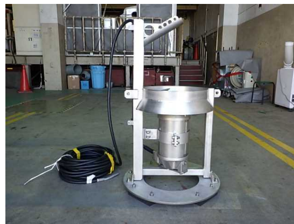
(攪拌装置側面部)
