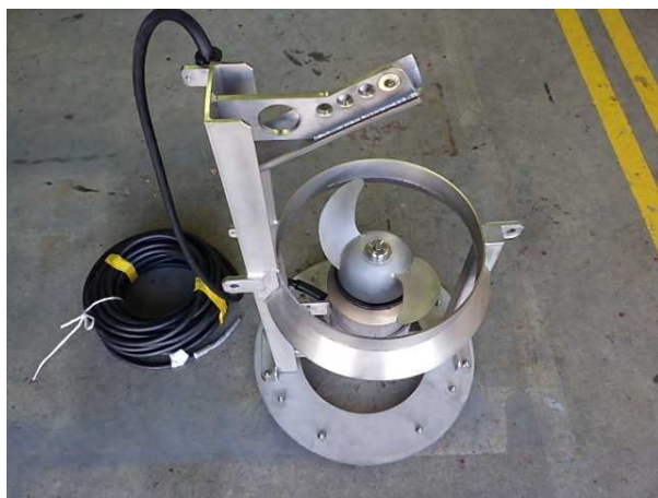
(攪拌装置上部)
