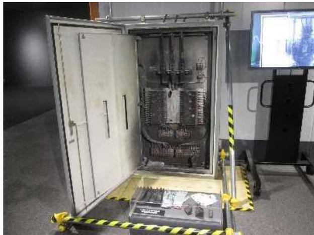
柏崎 5 号炉 定検用分電盤火災
