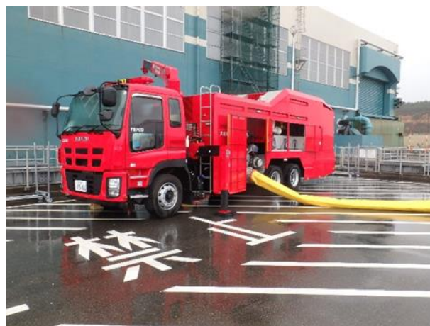
大容量送水車（熱交換器ユニット用）
