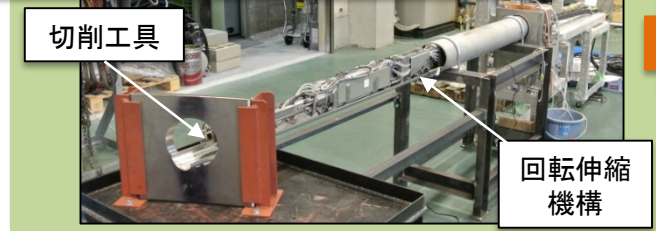
側部挿入型試料採取装置 (炉心タンク、防振板、制御棒案内管用)
