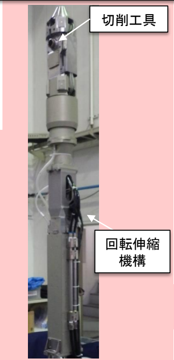
下部挿入型試料採取装置 (圧力管・カランドリア管用)
