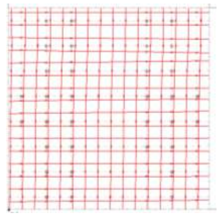
鉄筋探査結果をアンカー配置計画位置に対してプロット
