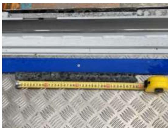
採取されたコンクリート小径コア(例)
