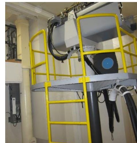
ラジオグラフィー装置 (電子ライナックX線発生装置)
