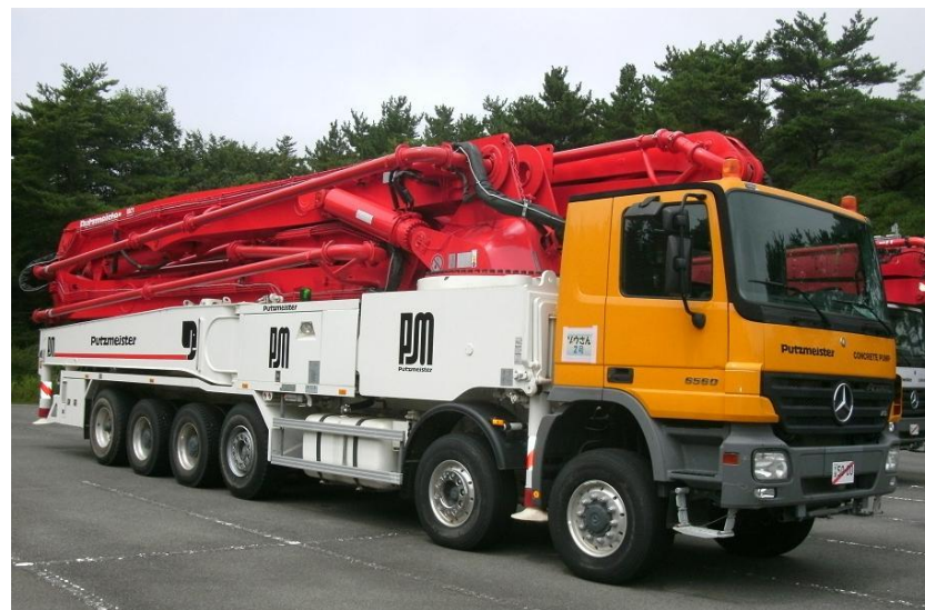
コンクリートポンプ車
