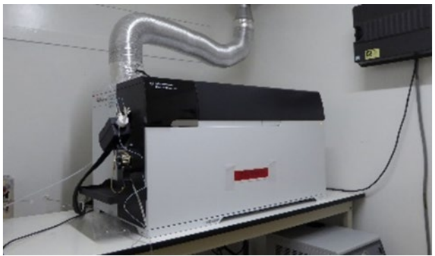
ICP-MS ・質量分析部；真空構造 ・試料導入部；洗浄操作⇒溶液回収
