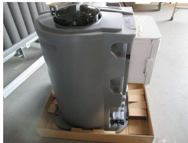
冷却塔 (薬注装置) (R3. 10. 15入荷)
