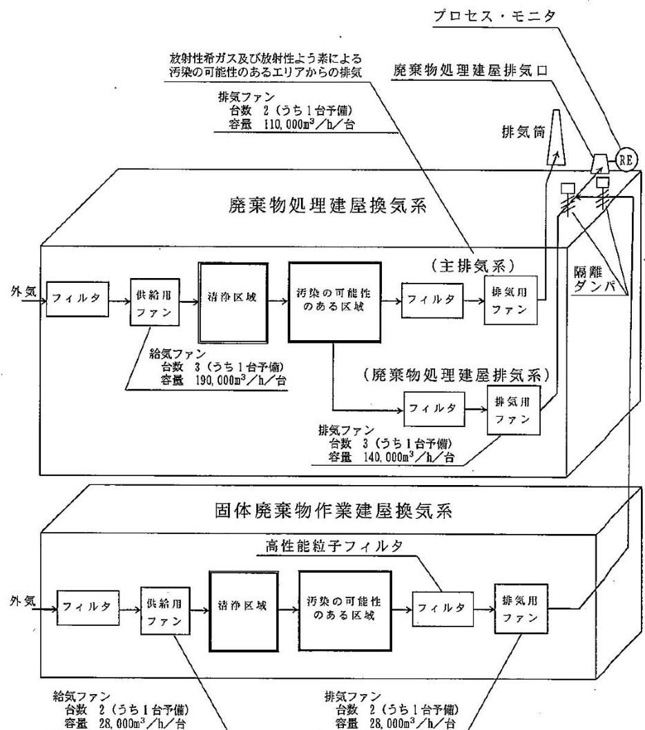
第 27-4 図 固体廃棄物作業建屋及び廃棄物処理建屋換気系 系統概略図
