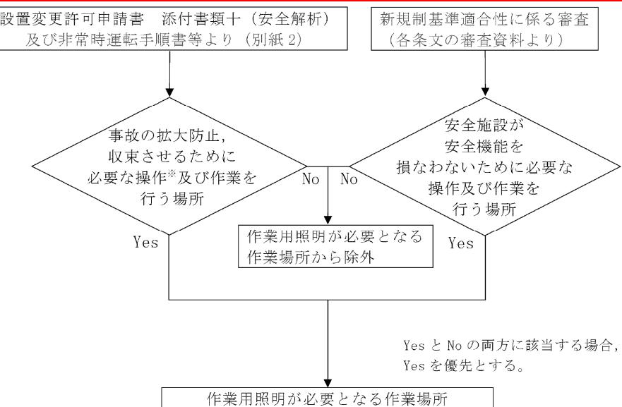
第 2.2.1-1 図 作業用照明が必要となる作業場所の抽出フロー
