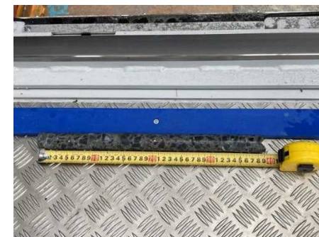
採取されたコンクリート小径コア
