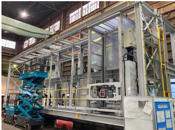
アンカー削孔装置フレーム
