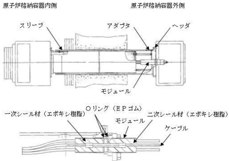
図 8-2 低圧用電気配線貫通部構造図
