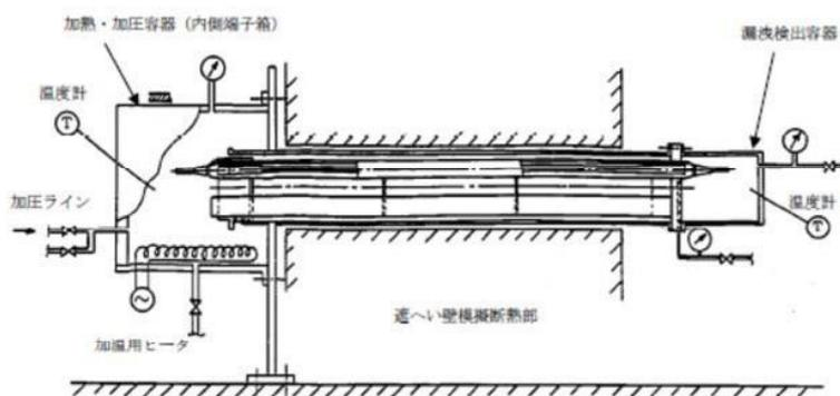
図8-4 電気ペネ共研の試験概要
