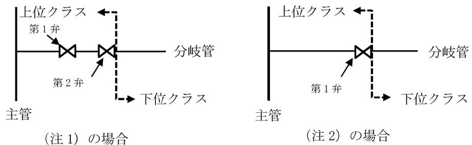
図 5-1 配管系中の取合点
