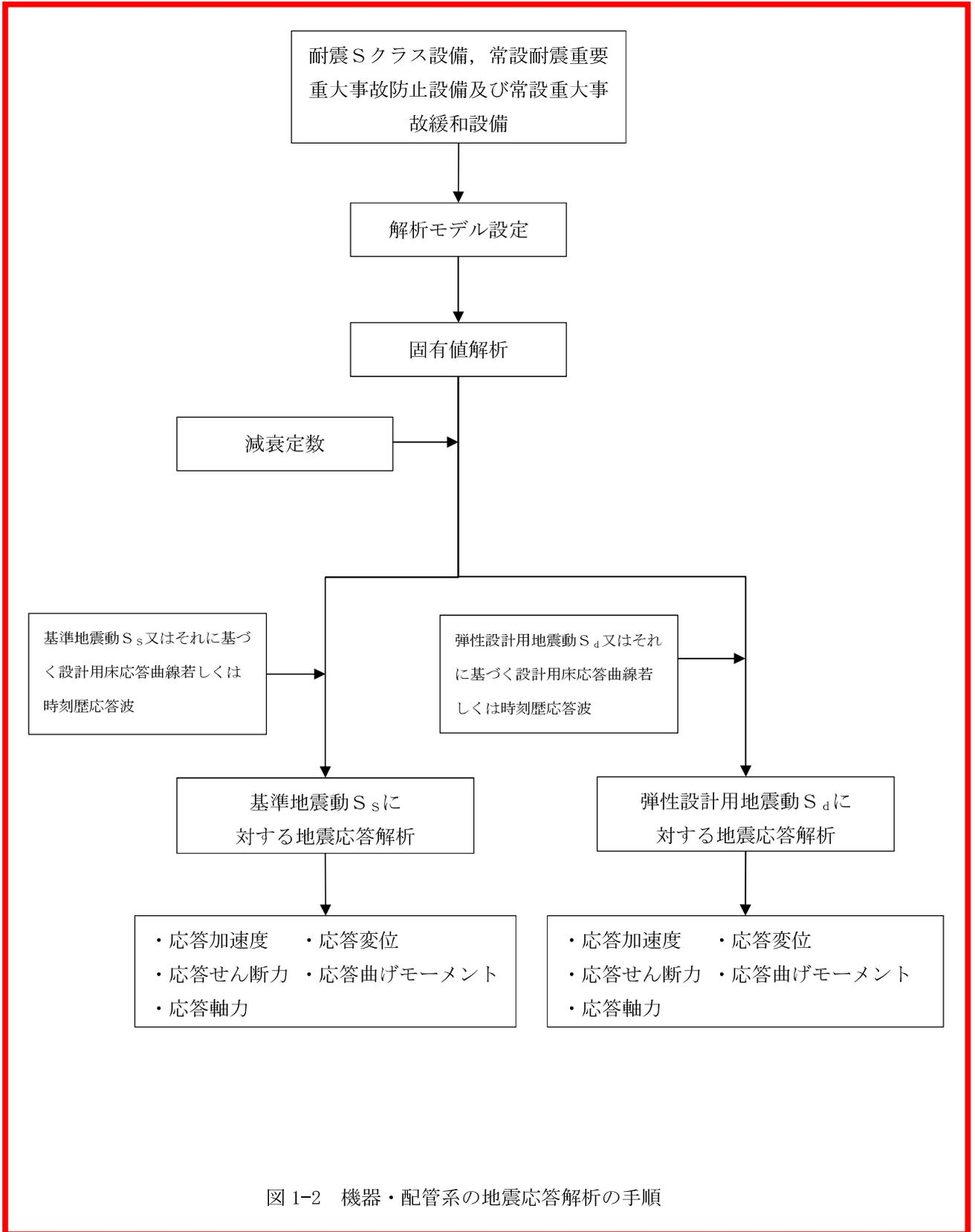
図 1-2 機器・配管系の地震応答解析の手順
