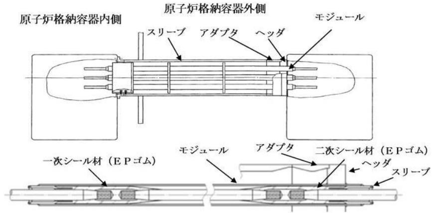
図 8-1 高圧用電気配線貫通部構造図
