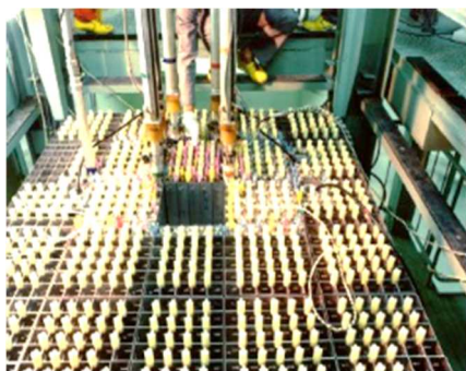
* 固体減速架台2基 (A, B架台)
