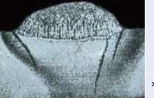
*2 | オーステナイト系ステンレス鋼であれば、一般に低温割れは生じない。また、低温割れの要因となる水素の混入が少ないTIG溶接と低水素系棒を使用した被覆アーク溶接で行っている。                                                                    |
