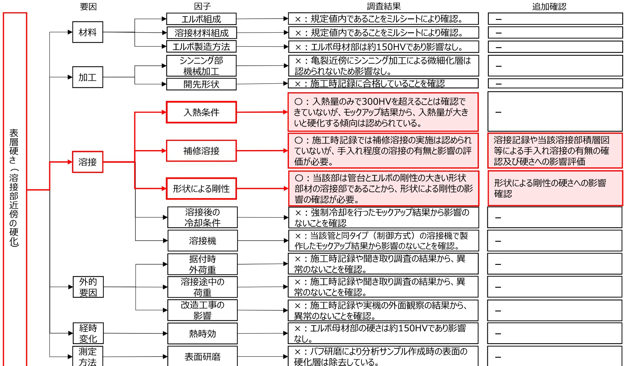
▶ 硬化要因としては、溶接入熱に加え補修溶接（手入れ溶接）、形状による剛性について追加確認が必要と判断した。
