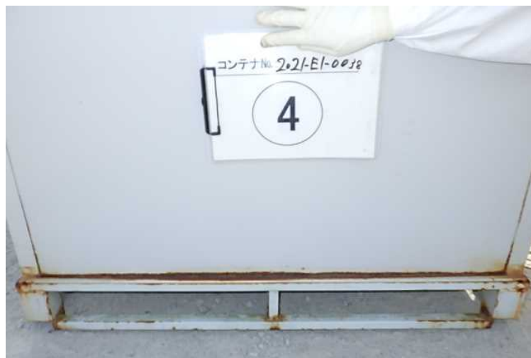
写真3.側面下部に著しい腐食があるコンテナ (E1エリア, 5月13日撮影)
