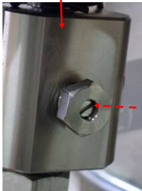
図-3 圧力ダンパー (脈動を緩衝するために使用する継手)
