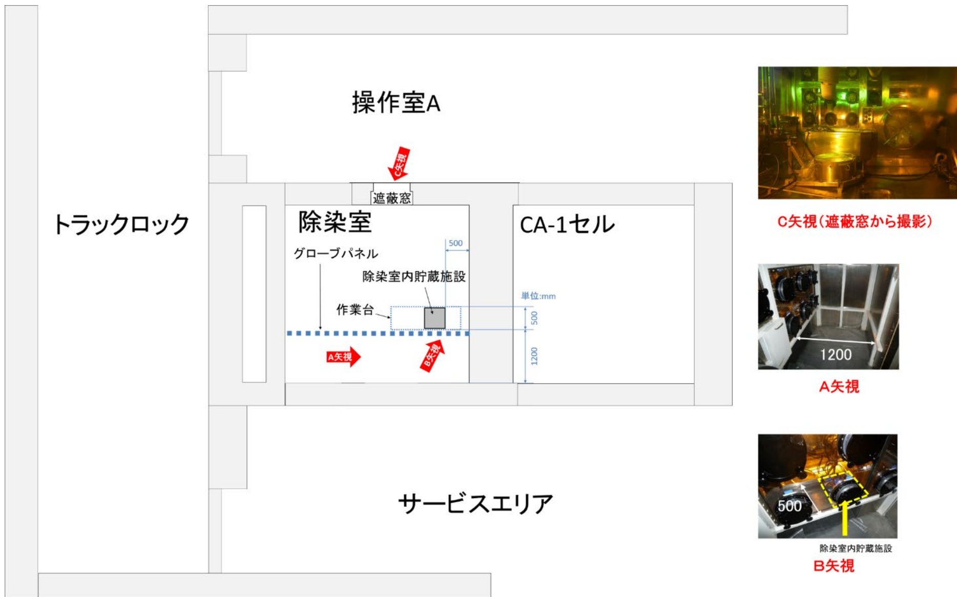
図 3 - 1 除染室内貯蔵施設の位置と外観
