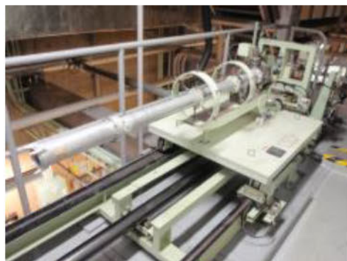
横搬送装置写真
