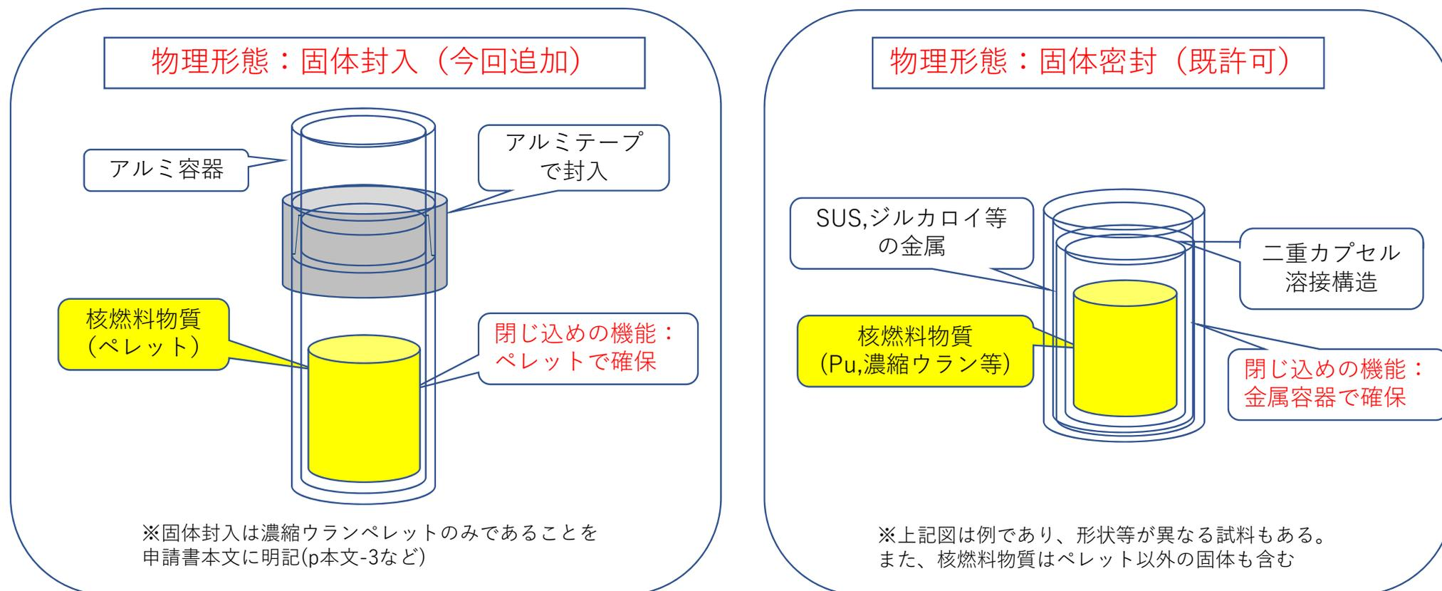
図. 固体封入及び固体密封試料の概略図
