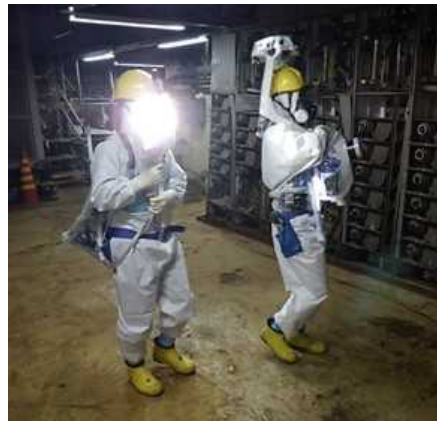
照明とウェアラブル型3Dスキャン装置 (4号機におけるモックアップの様子)
