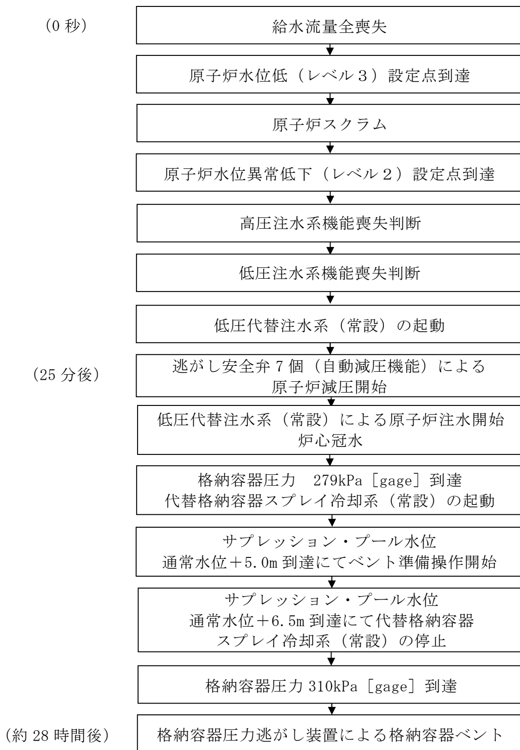
第 4.1.1-1 図 高压・低压注水機能喪失の重要事故シーケンスの概要
