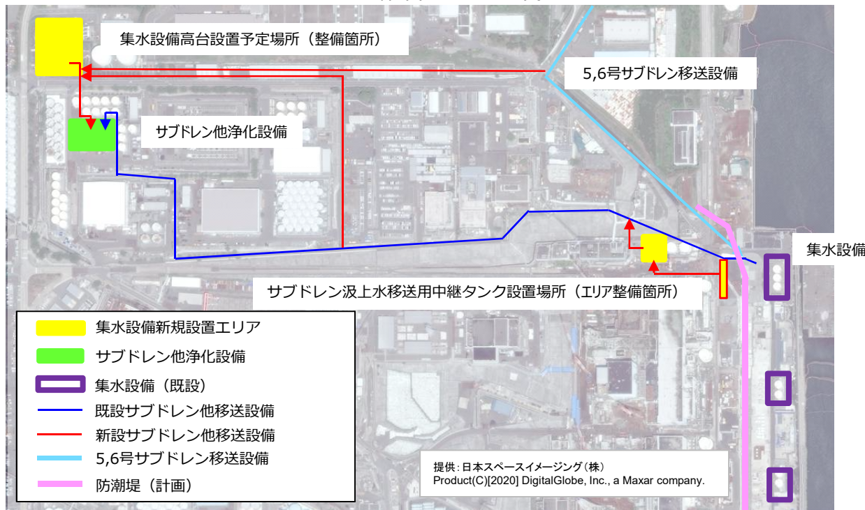
サブドレン移送配管計画図（案）
