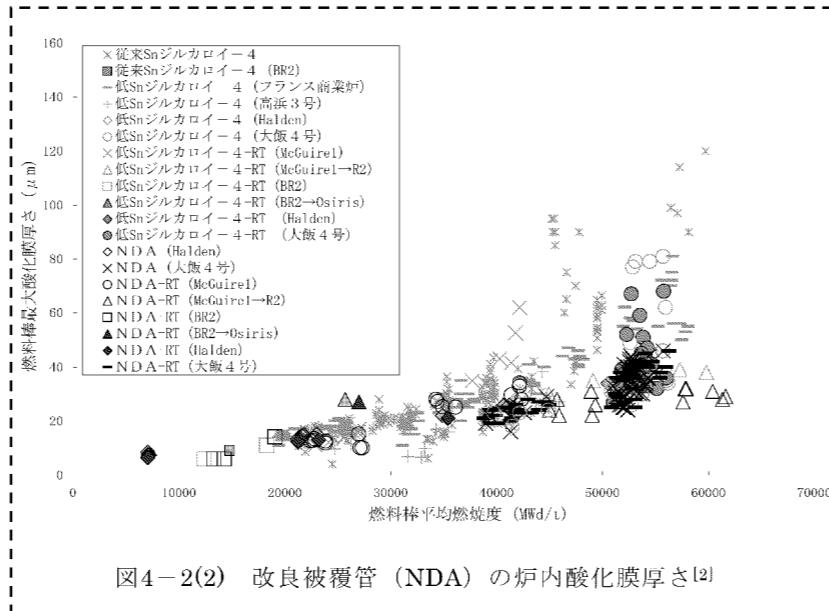
図4-2(2) 改良被覆管（NDA）の炉内酸化膜厚さ<sup>[2]</sup>
