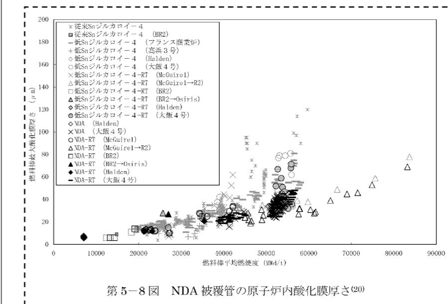
第5-8図 NDA被覆管の原子炉内酸化膜厚さ<sup>(20)</sup>
