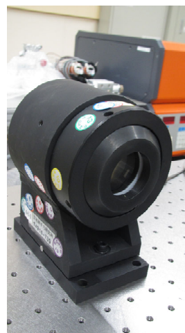
図1 ファブリペロー干渉計（115号室）の外観写真
