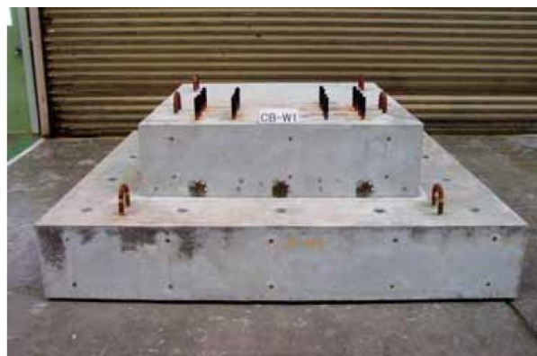
補足-4図 型枠脱型後の試験体
