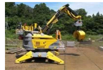
使用する遠隔操作重機（BROKK400D）
