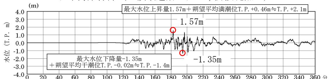
第9図(2) 基準津波の時刻歴波形
