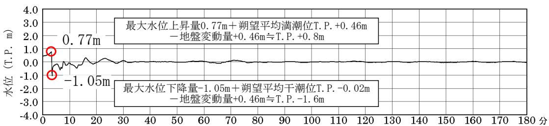
第9図(1) 基準津波の時刻歴波形
