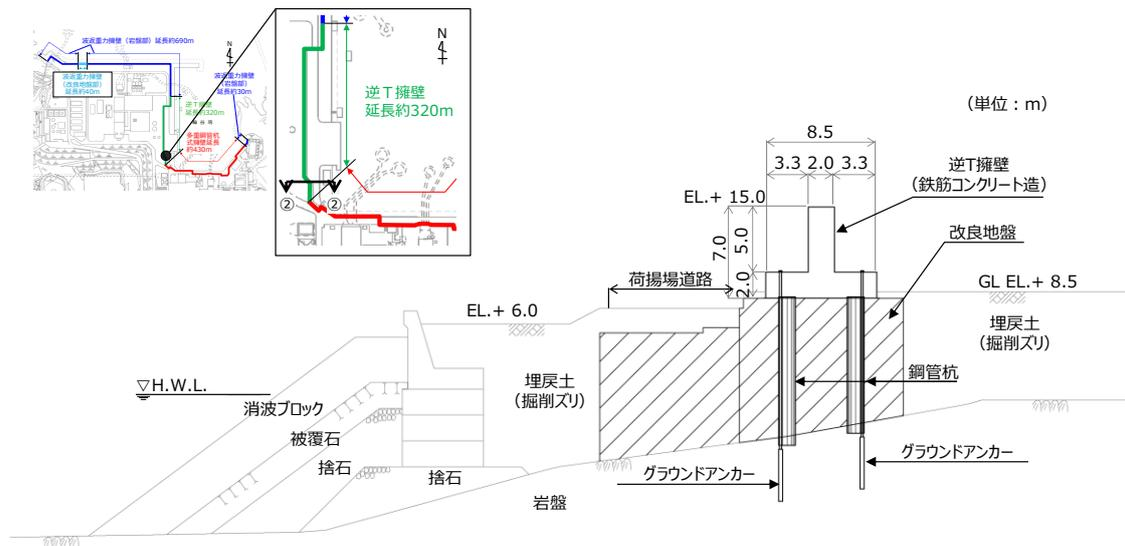
第 6-4(2) 図 防波壁（逆 T 擁壁）荷揚護岸南側部
