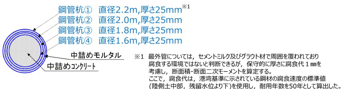
$$\text{断面二次モーメント } I^{※2} = I_{①} + I_{②} + I_{③} + I_{④}$$
