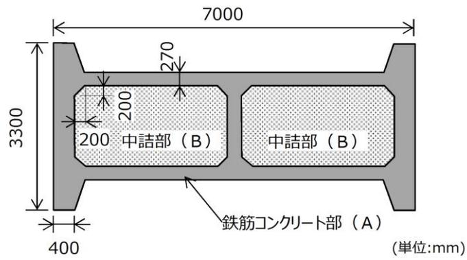
第9-26 図 セルラーブロック平面図 (例)
