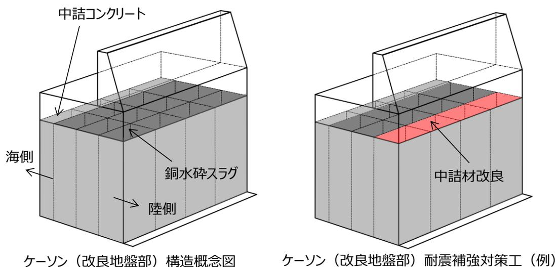
第 7-34 図 ケーソン(改良地盤部)構造概念及び耐震補強対策工(例)
