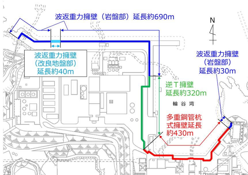
第4-1図 防波壁の平面図
