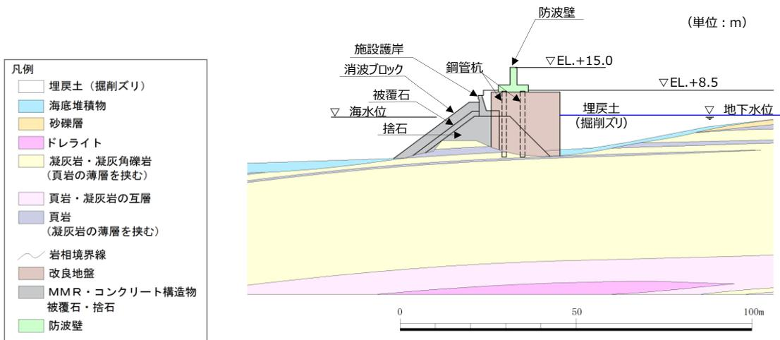
第 6-15 図 防波壁 (逆 T 擁壁) の地質断面図 (⑤-⑤)
