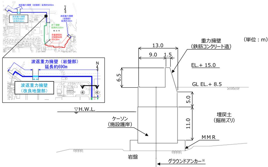
※ 防波壁（波返重力擁壁）は、グラウンドアンカーの効果を期待しなくても、耐震・耐津波安全性を担保している。
