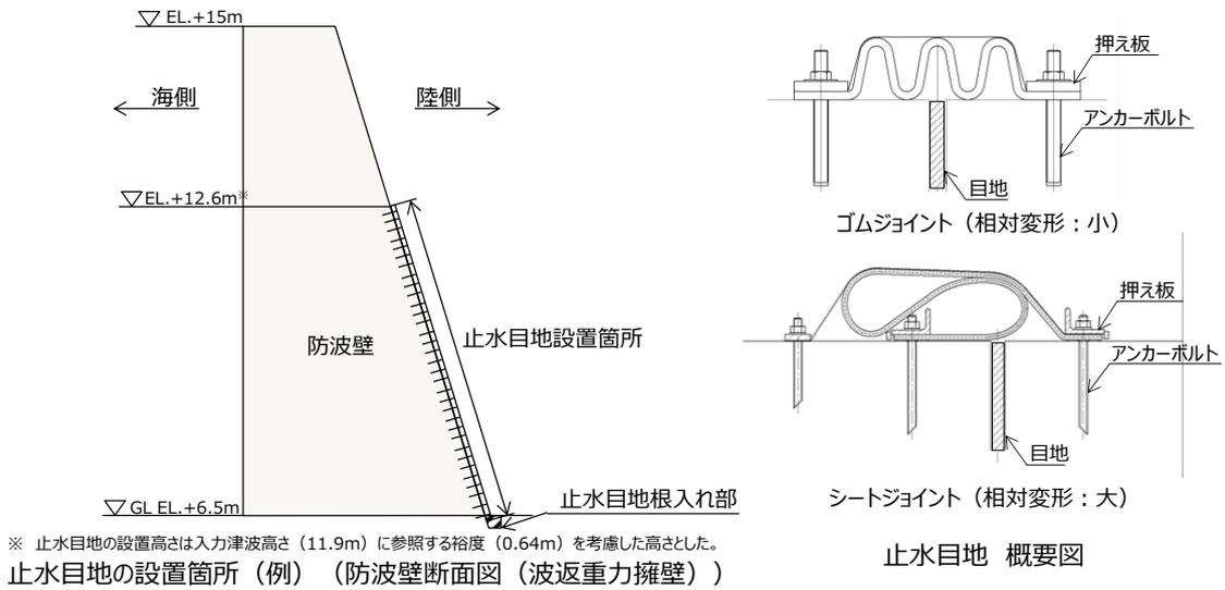
第 8-1 図 防波壁の止水目地の設置箇所及び概要図
