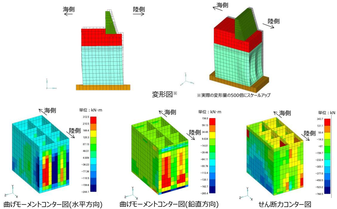
第10-5-13 図 3次元静的FEM解析結果（輪谷部）
