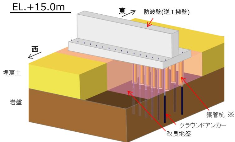
※ 防波壁（逆T擁壁）は，鋼管杭の効果を期待しなくても，耐震・耐津波安全性を担保している。
