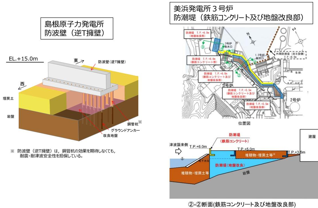
第6-38図 構造イメージ（島根原子力発電所 防波壁（逆T擁壁）及び美浜発電所3号炉防潮堤（鉄筋コンクリート及び地盤改良部）
