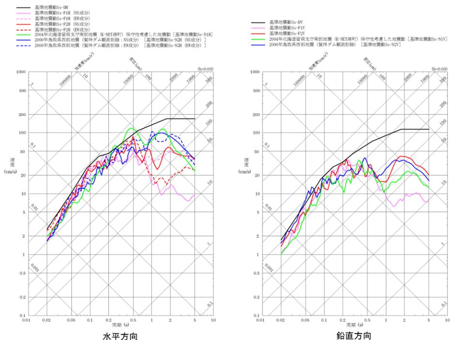
第 4-5 図 基準地震動 S s の応答スペクトル
