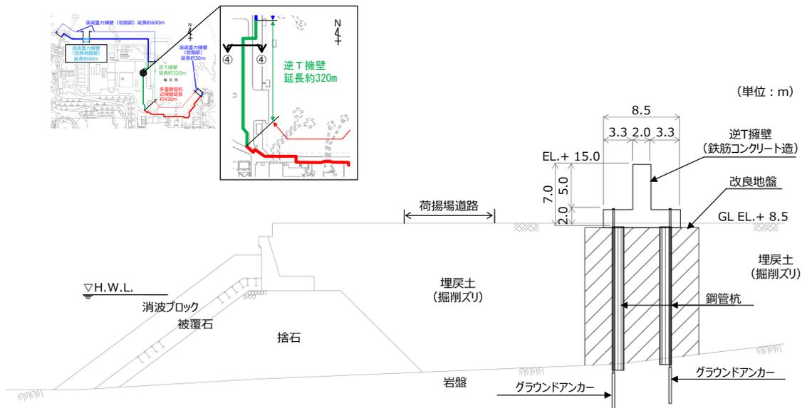
第6-4(4) 図 防波壁（逆T擁壁）防波扉南側部
