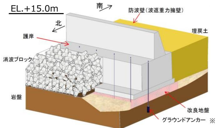
※ 防波壁（波返重力擁壁）は，グラウンドアンカーの効果を期待しなくても，耐震・耐津波安全性を担保している。
