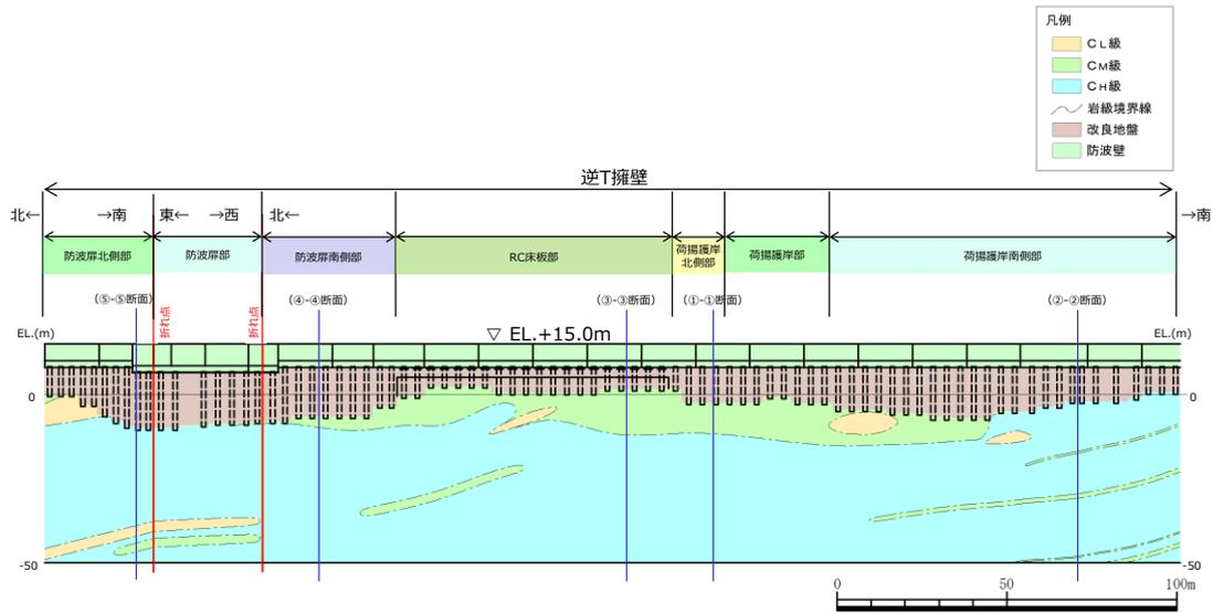
第6-11 図 防波壁（逆T擁壁）の岩級縦断面図
