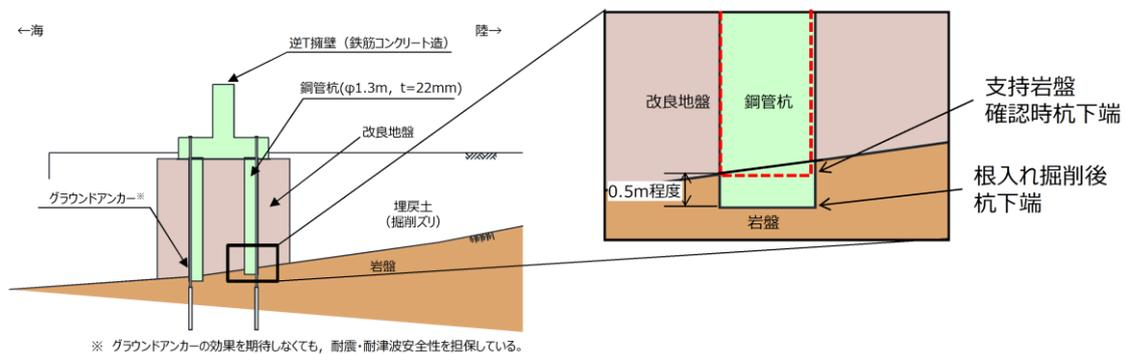
第6-29 図 鋼管杭根入れ状況イメージ図
