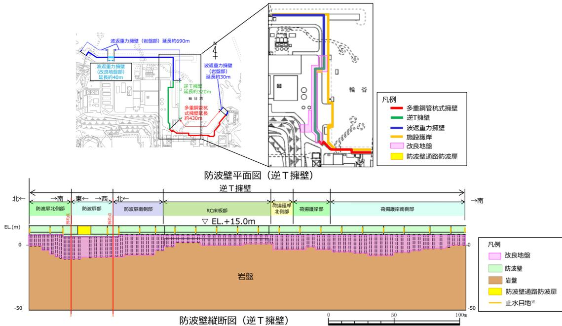
※止水目地の設置高さ及び根入れ長については、敷地の地盤高さ及び入力津波高さを踏まえて設定する。
