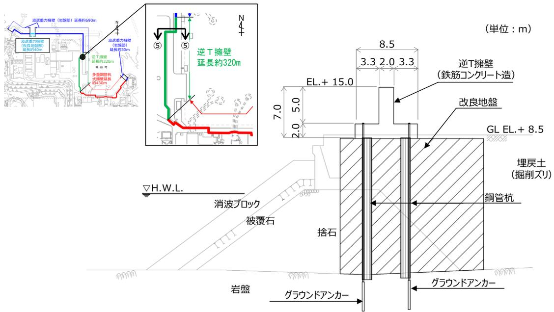
第 6-4(5) 図 防波壁 (逆 T 擁壁) 防波扉北側部
