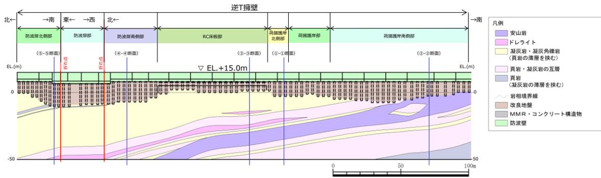
第 10-2-5 図 構造成立性評価断面候補地点の断面図
