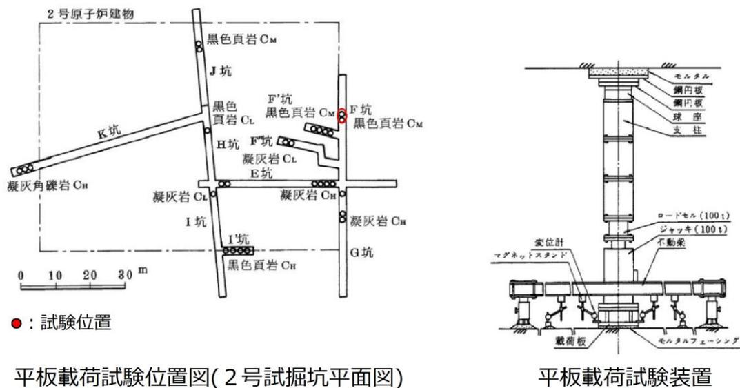
平板載荷試験位置図(2号試掘坑平面図)
