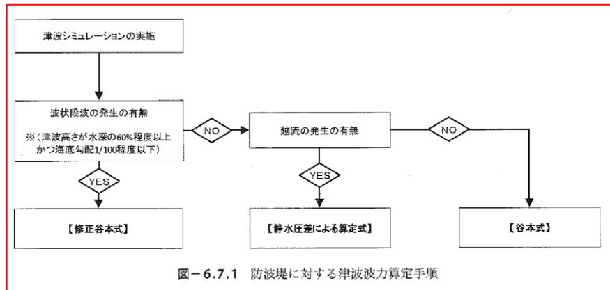
防波堤に作用する津波波力を求めるための津波高さの算定は、防波堤を設置した条件で行う数値シミュレーション結果を用いることを原則とする。谷本式、修正谷本式に用いる入射津波の静水面上の高さ $a_1$ は、数値シミュレーション等による津波高さ（基準水面からの高さ）の1/2を入射津波高さとして定義し、波力算定にはこれを用いる。ここで、基準面とは津波が作用する面において津波高を算定するための基準となる水位である。一般に、津波高さという場合には、浸水等の影響を考慮するための水位（反射波の影響を含む）である。したがって、これらの津波高さについても、原則としてその1/2の値を入射津波高さ $a_1$ とする。こうした津波高さは一般にT.P.上の水位で表されていることが多いので、設計潮位（通常はH.W.L.）上の高さに換算してから1/2にする必要がある。
