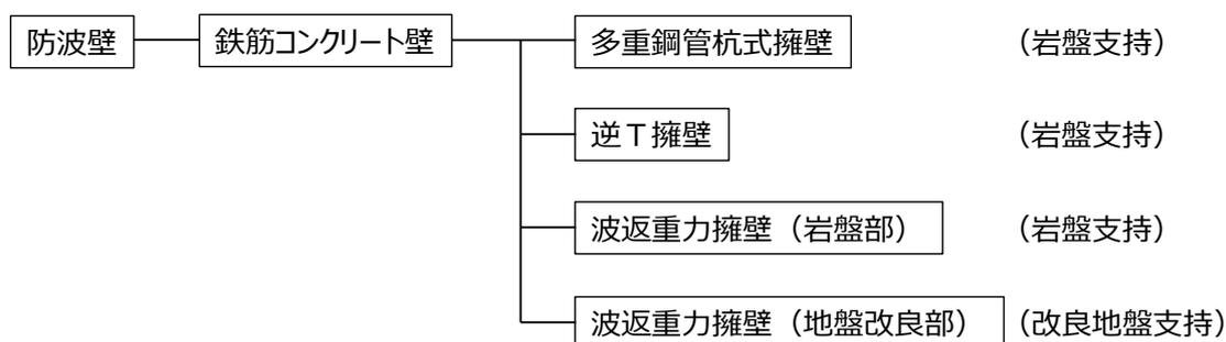
防波壁は、地震後及び津波後の再使用性と津波の繰り返し作用を考慮し、構造物全体の変形能力に対して十分な裕度を有するよう設計する。設計においては、地盤の液状化の影響を考慮する。また、津波の検討においては地震による影響を考慮したうえで評価する。
