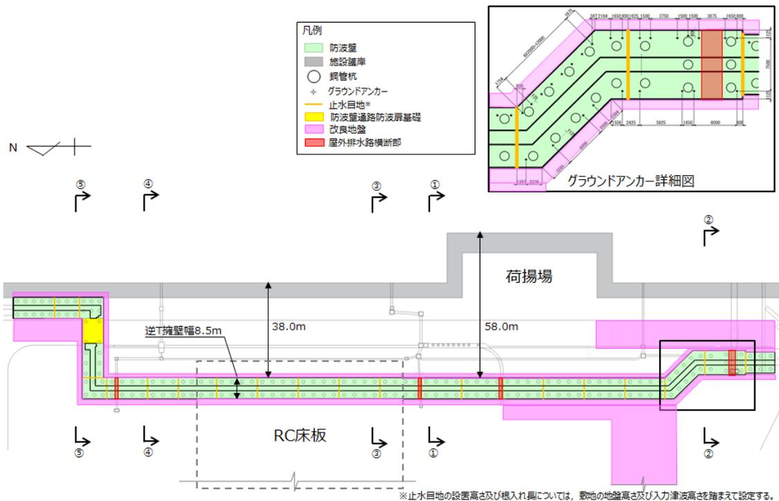
※止水目地の設置高さ及び根入れ長については、敷地の地盤高さ及び入力津波高さを踏まえて設定する。
