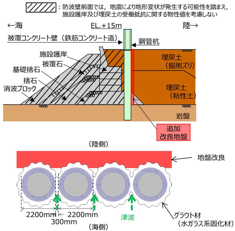
第5-44 図 改良地盤の設置イメージ図 (例)
