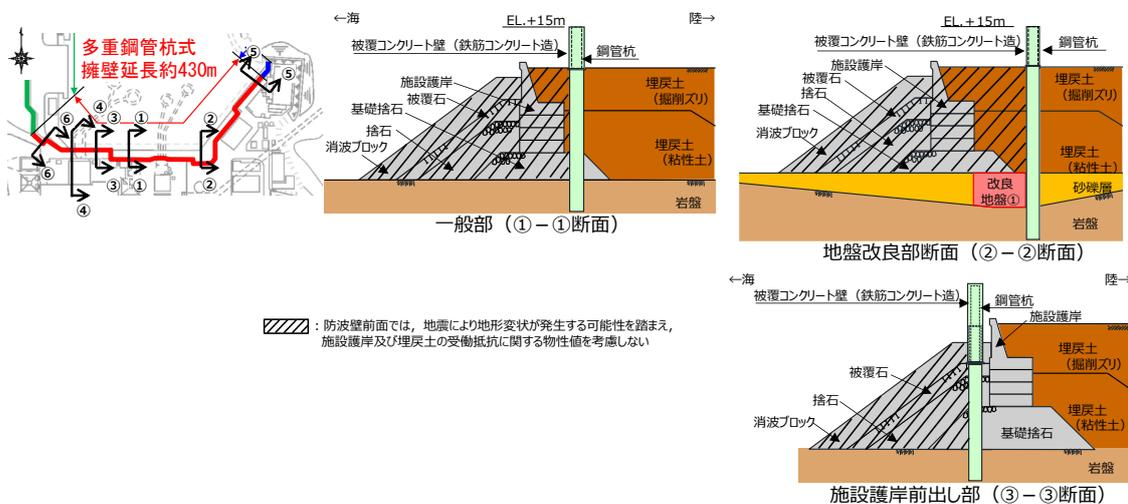
第5-42 図 選定した各断面の検討概要図
