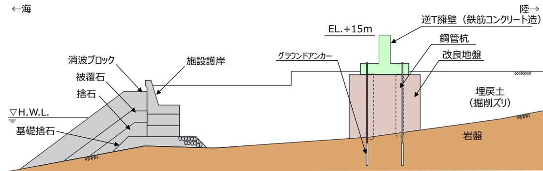
第6-5 図 防波壁（逆T擁壁）構造概要図
