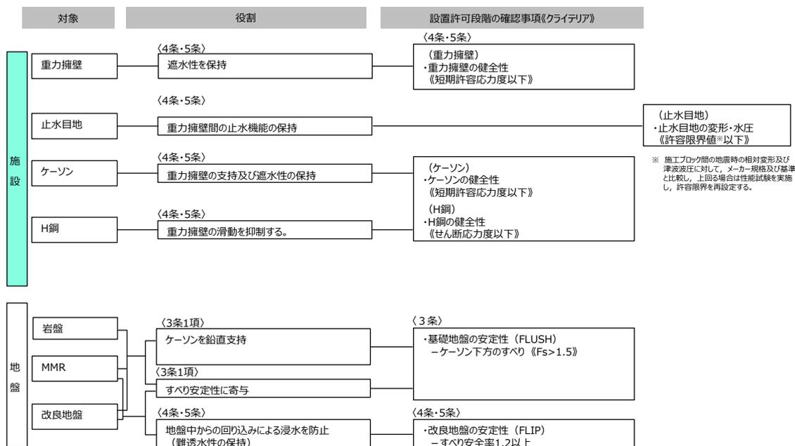
第9-3図 設置許可段階における確認項目 [防波壁（波返重力擁壁）]
