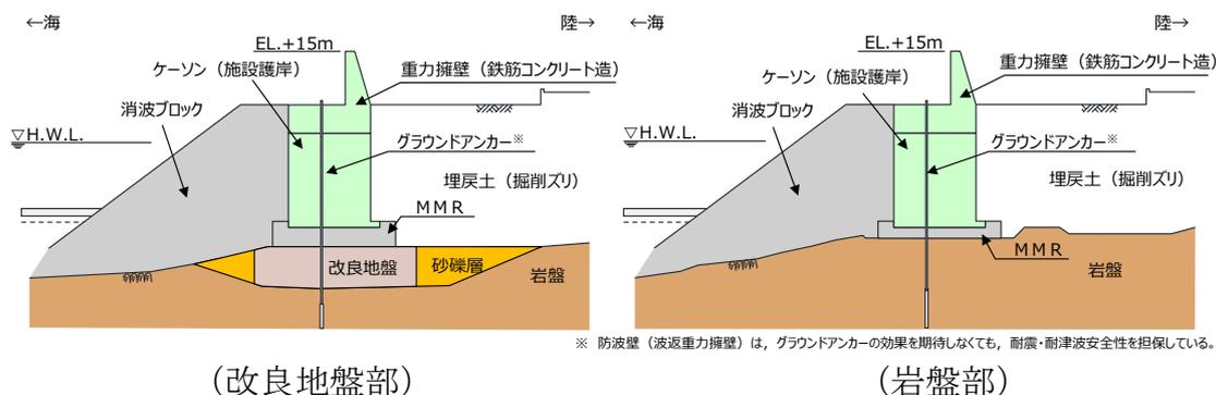
第7-7図 防波壁（波返重力擁壁）断面図
