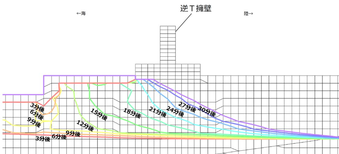
第10-6-2 図 2次元浸透流解析結果
