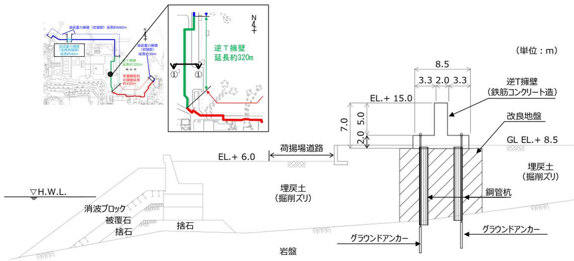
第 6-4(1) 図 防波壁（逆 T 擁壁）荷揚護岸北側部
