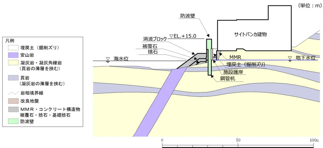
第5-16 図 防波壁（多重鋼管杭式擁壁）の地質断面図（⑤-⑤）
