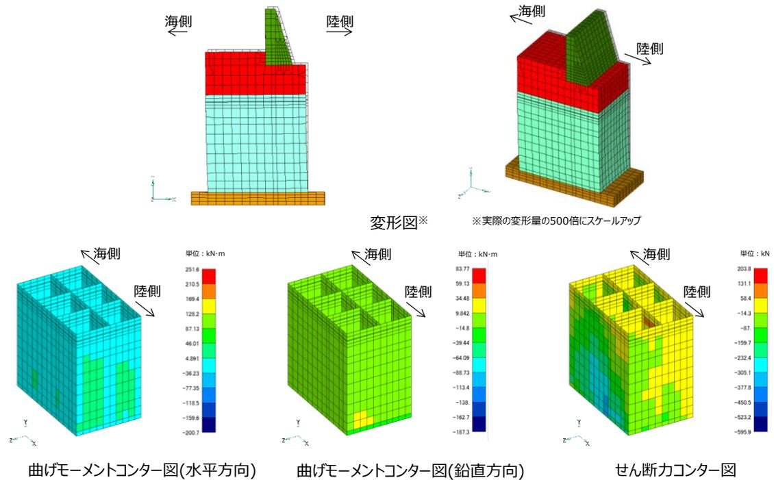
第10-5-12図 3次元静的FEM解析結果（輪谷部）
