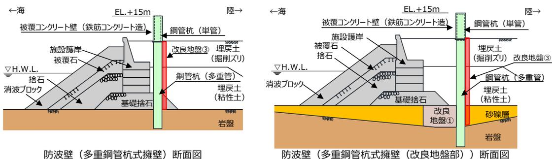
防波壁（多重鋼管杭式擁壁）断面図
