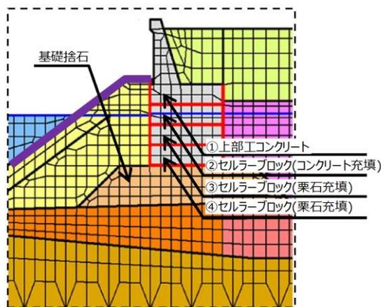
第 9-25 図 施設護岸部 解析モデル拡大図
