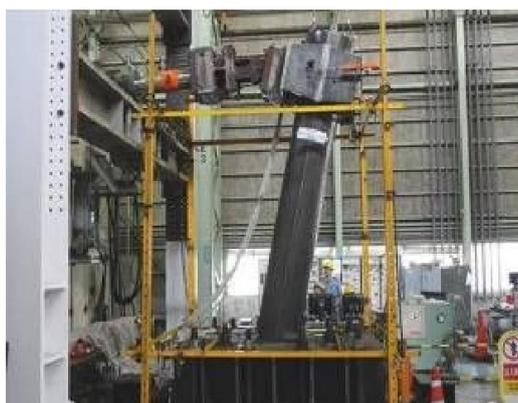
第 5-38 図 最大荷重時座屈状況
