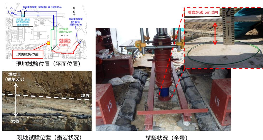
第6-33 図 防波壁（逆T擁壁）平板載荷試験概要
