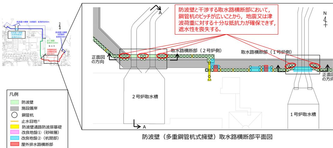
※止水目地の設置高さ及び根入れ長については、敷地の地盤高さ及び入力津波高さを踏まえて設定する。
