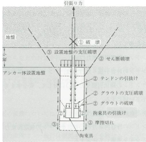
第6-17 図 ある種のアンカー形式の破壊概念例
