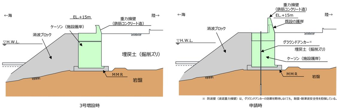
※ 防波壁（波返重力擁壁）は、グラウンドアンカーの効果も期待しなくても、耐震・耐津波安全性を担保している。
