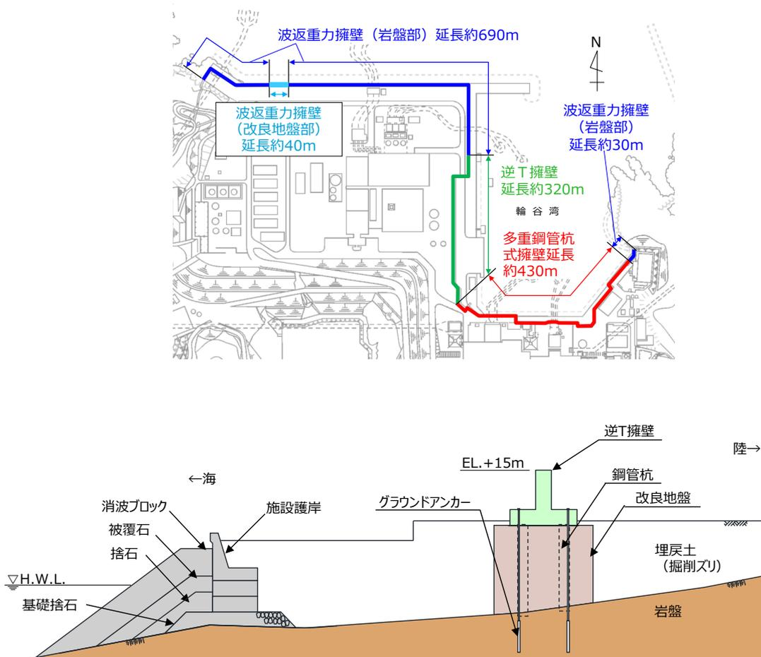
第6-1図 防波壁（逆T擁壁）断面図
