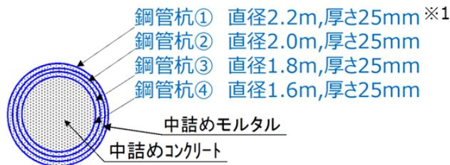
※1 最外管については，セメントミルクで周囲を覆われており腐食する環境ではないと判断できるが，保守的に厚さに腐食代 1 mm を考慮し，断面積・断面二次モーメントを算定する。ここで，腐食代は，港湾基準に示されている鋼材の腐食速度の標準値(陸側土中部，残留水位より下)を使用し，耐用年数を 50 年として算出した。
