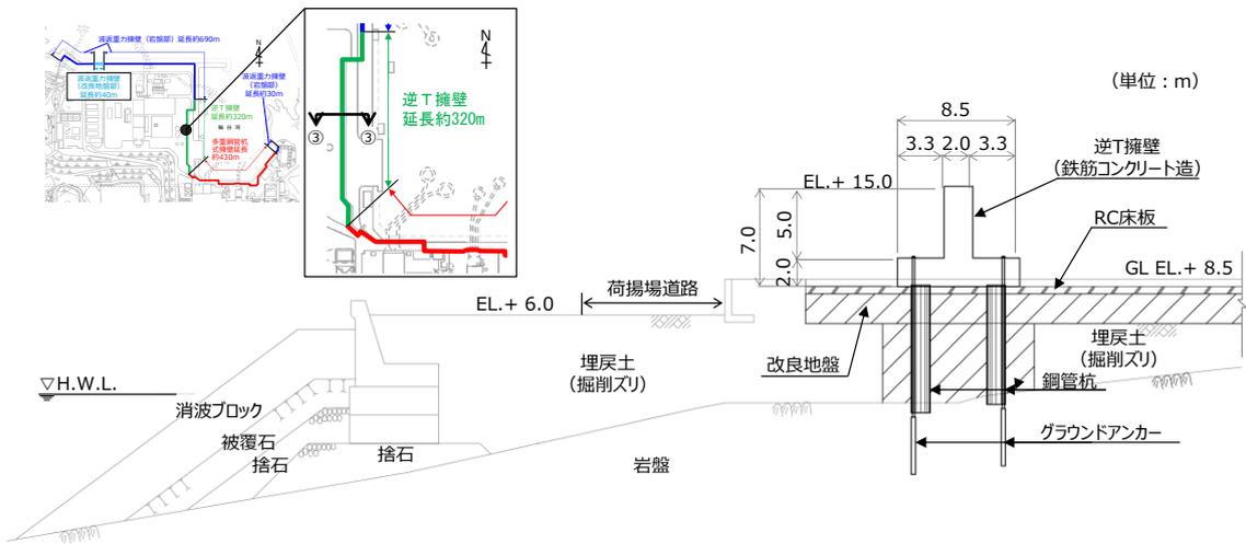
第6-4(3) 図 防波壁（逆T擁壁）RC床版部
