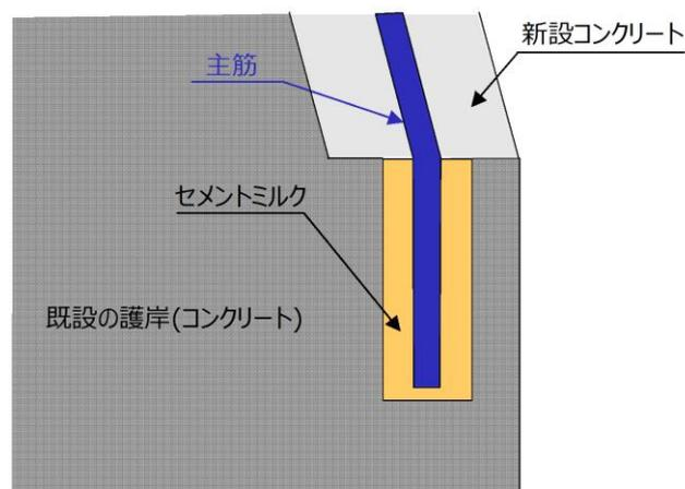
第 7-41 図 定着部の構造（陸側主筋）
