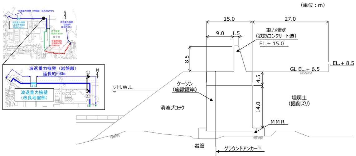
※ 防波壁 (波返重力擁壁) は、グラウンドアンカーの効果を期待しなくても、耐震・耐津波安全性を担保している。
