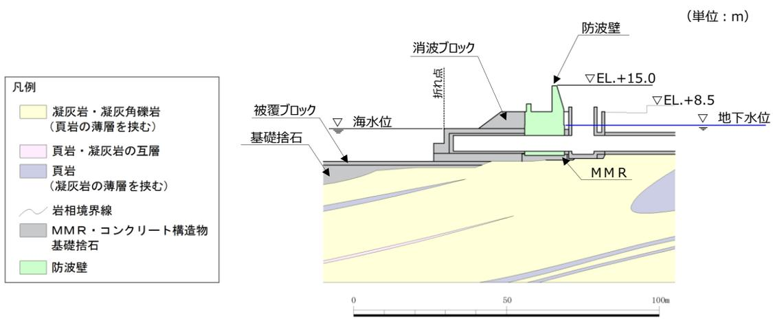
第7-15 図 防波壁 (波返重力擁壁) の地質断面図 (③-③)
