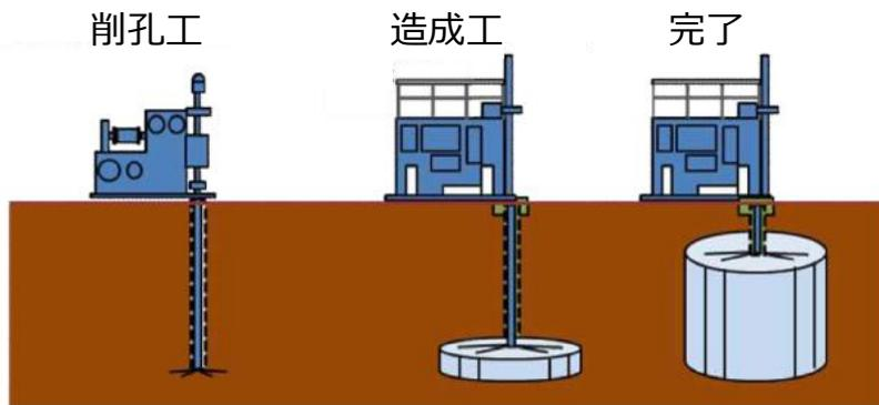
高圧噴射攪拌工法の施工イメージ
