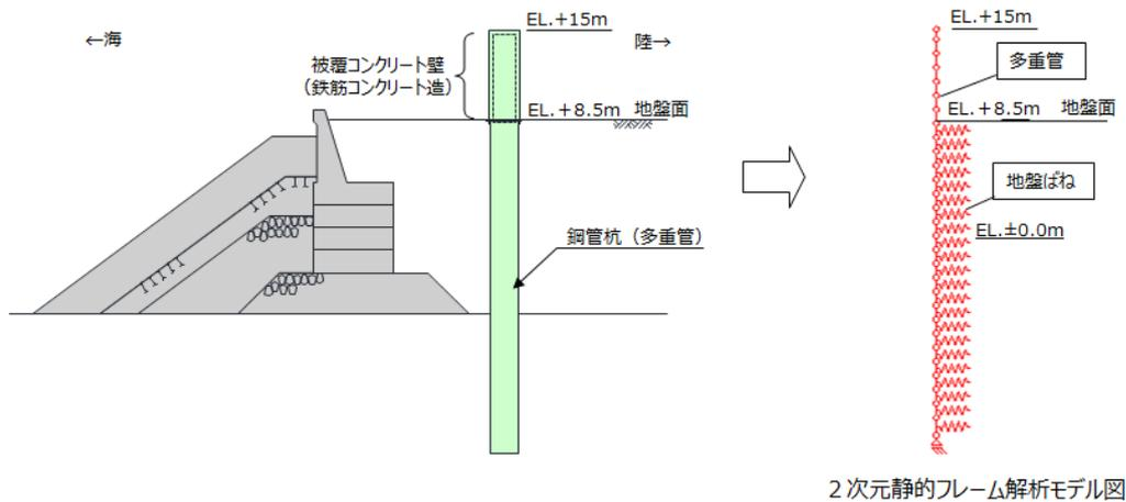
第10-3-3 図 多重鋼管杭のモデル化 (津波時)
