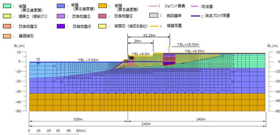
第6-20 図 防波壁（逆T擁壁）の解析モデル
