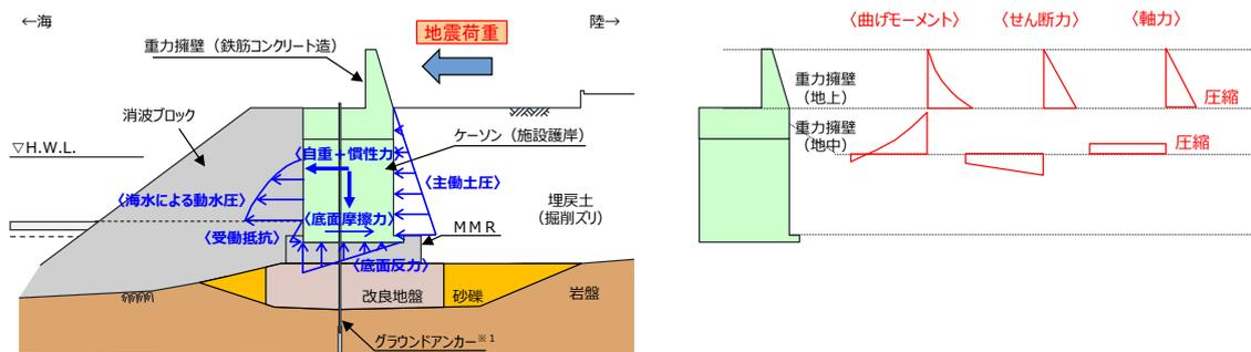
※1 防波壁（波返重力擁壁）は、グラウンドアンカーの効果も期待しなくても、耐震・耐津波安全性を担保している。
