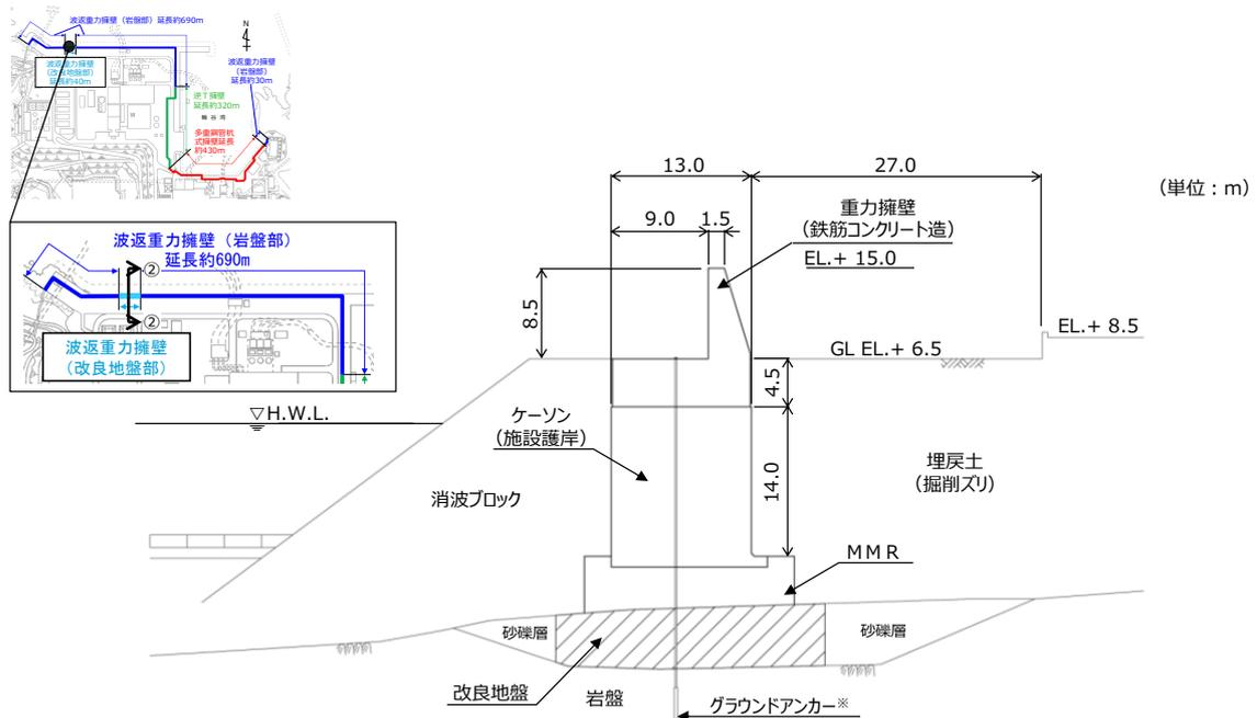
※ 防波壁 (波返重力擁壁) は、グラウンドアンカーの効果を期待しなくても、耐震・耐津波安全性を担保している。
