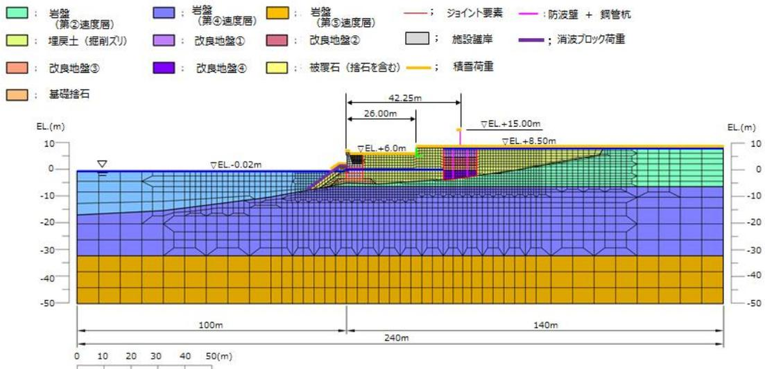
第 10-4-3 図 逆T擁壁の解析モデル (津波時)
