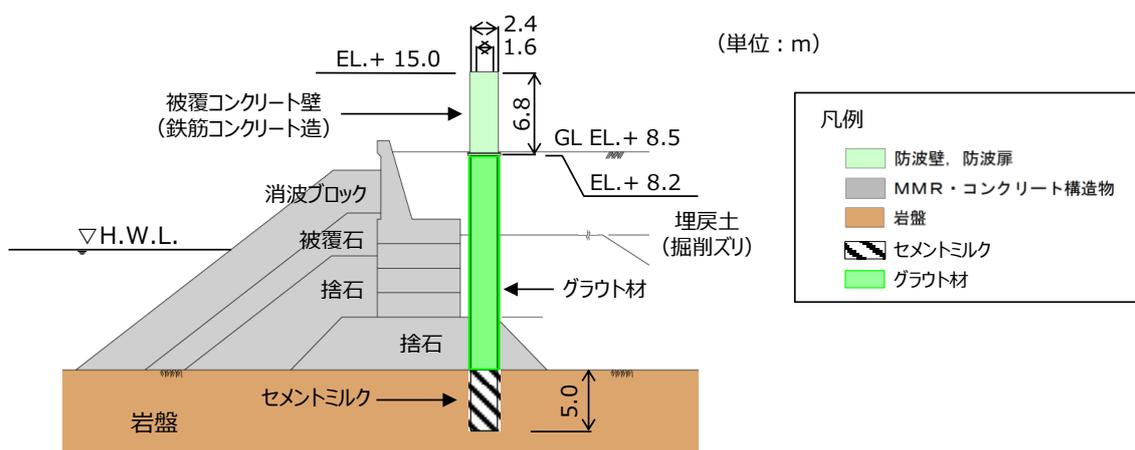
第5-30 図 防波壁（多重鋼管杭式擁壁）弱部③概要図
