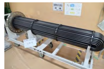
蒸気発生器の点検整備
