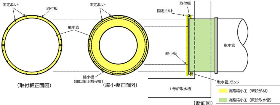
1号炉取水槽流路縮小工 拡大図
