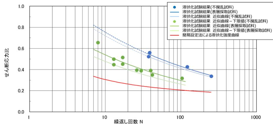
液状化強度曲線（埋戻土（掘削ズリ））
