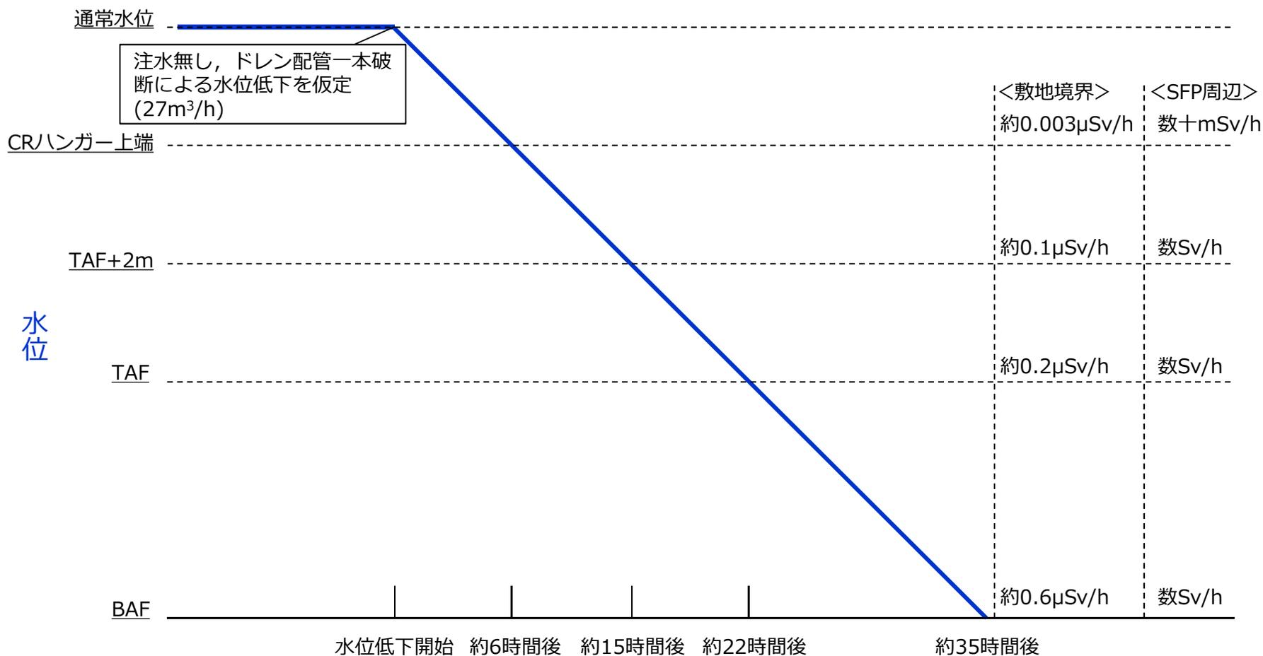
図. SFP水位とオペフロ線量の関係（1号機）
