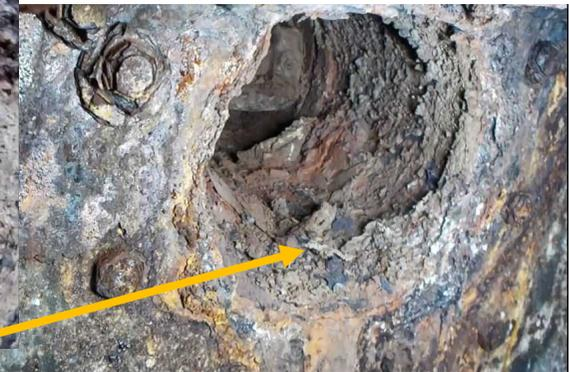
配管内部の状況：錆等の堆積物が確認された。
