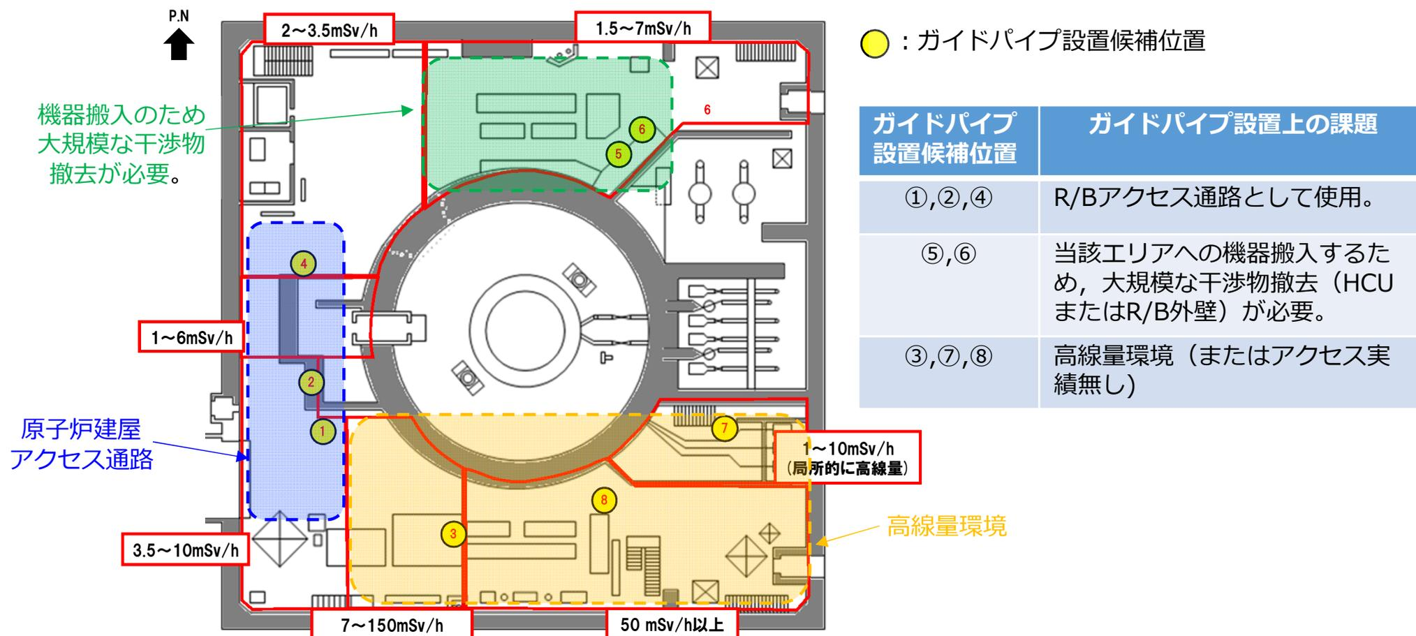
1号機原子炉建屋のガイドパイプ設置候補位置(①～⑧)
