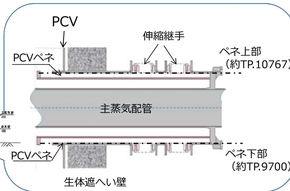
主蒸気配管貫通部 拡大図
