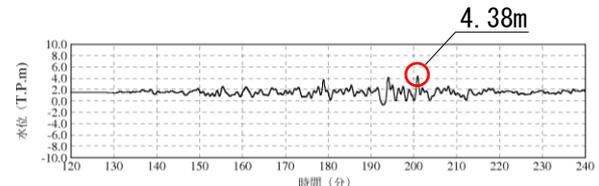
3号炉放水槽(循環水ポンプ運転時)
