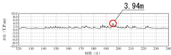
1号炉放水槽(循環水ポンプ停止時)
