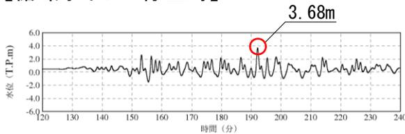
1号炉取水槽(循環水ポンプ停止時)
