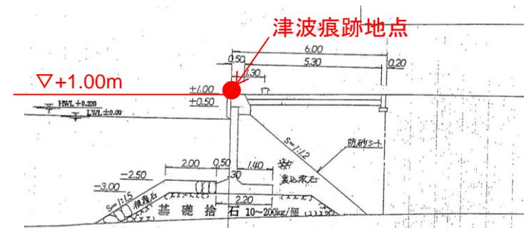
図3 津波痕跡地点における岸壁の断面図
