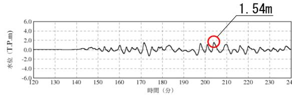
2号炉取水槽(循環水ポンプ運転時)
