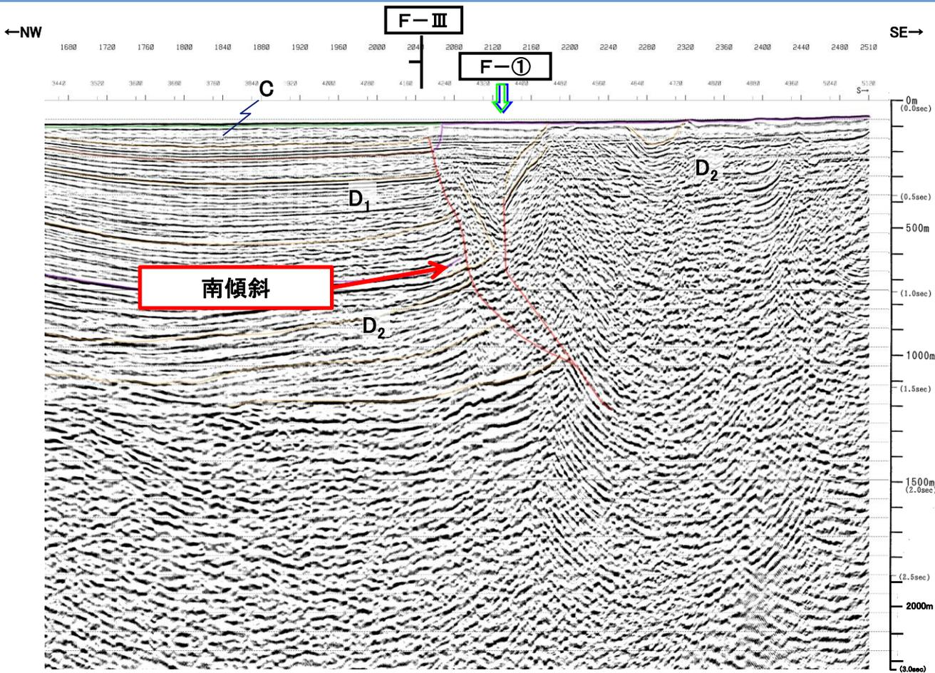
音波探査解析図(エアガン・マルチチャンネル)
