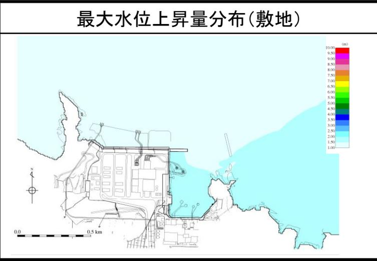
・地すべりM③による津波の敷地への影響は、海底地すべりに起因する津波の検討(地すべり①)と比較して小さいことを確認した。また、益田市以西で津波水位が比較的大きくなっており、文献の記載内容と整合することを確認した。
