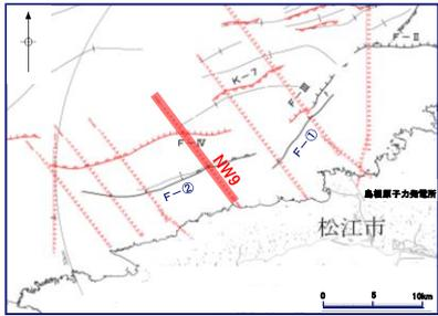
・F-②断層はD<sub>2</sub>層下部に変位が、D<sub>2</sub>層上部に変形が認められる。
