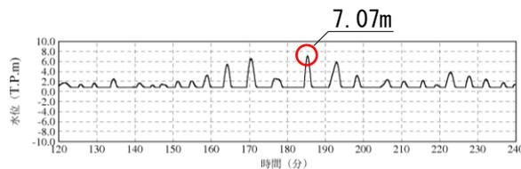
2号炉放水槽(循環水ポンプ停止時)
