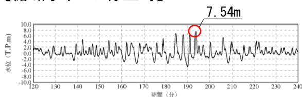
1号炉取水槽(循環水ポンプ停止時)
