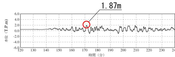
2号炉取水槽(循環水ポンプ停止時)
