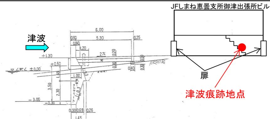
図3 津波痕跡地点における岸壁の断面図
