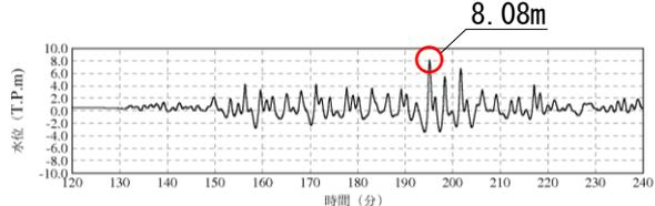
2号炉取水槽(循環水ポンプ停止時)
