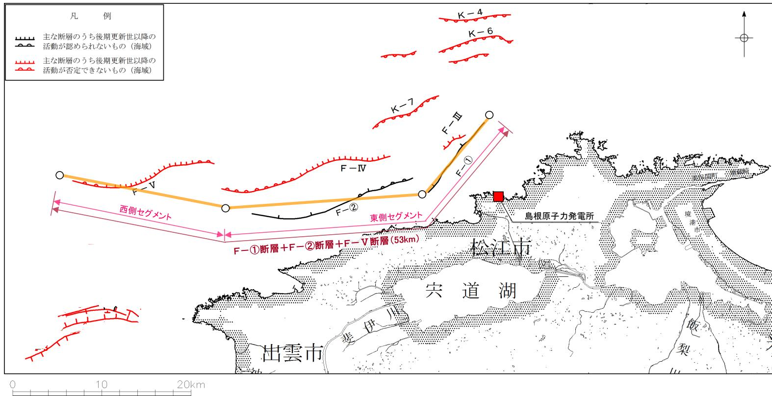
F-①断層+F-②断層+F-V断層による地震の断層モデル
