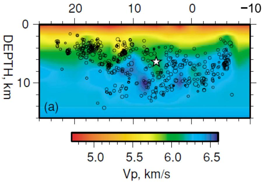
[☆は本震の破壊開始点、○は余震を示す。]
