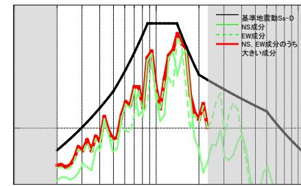
※施設の設計では、水平方向の各成分の建物応答のうち、大きい方の値を用いる方針としているため、水平方向の応答スペクトル比の算定においては、施設への影響を考慮し、対象周期帯の各周期の地震動レベルが大きい方の応答スペクトル(下図の赤線)を用いる。
