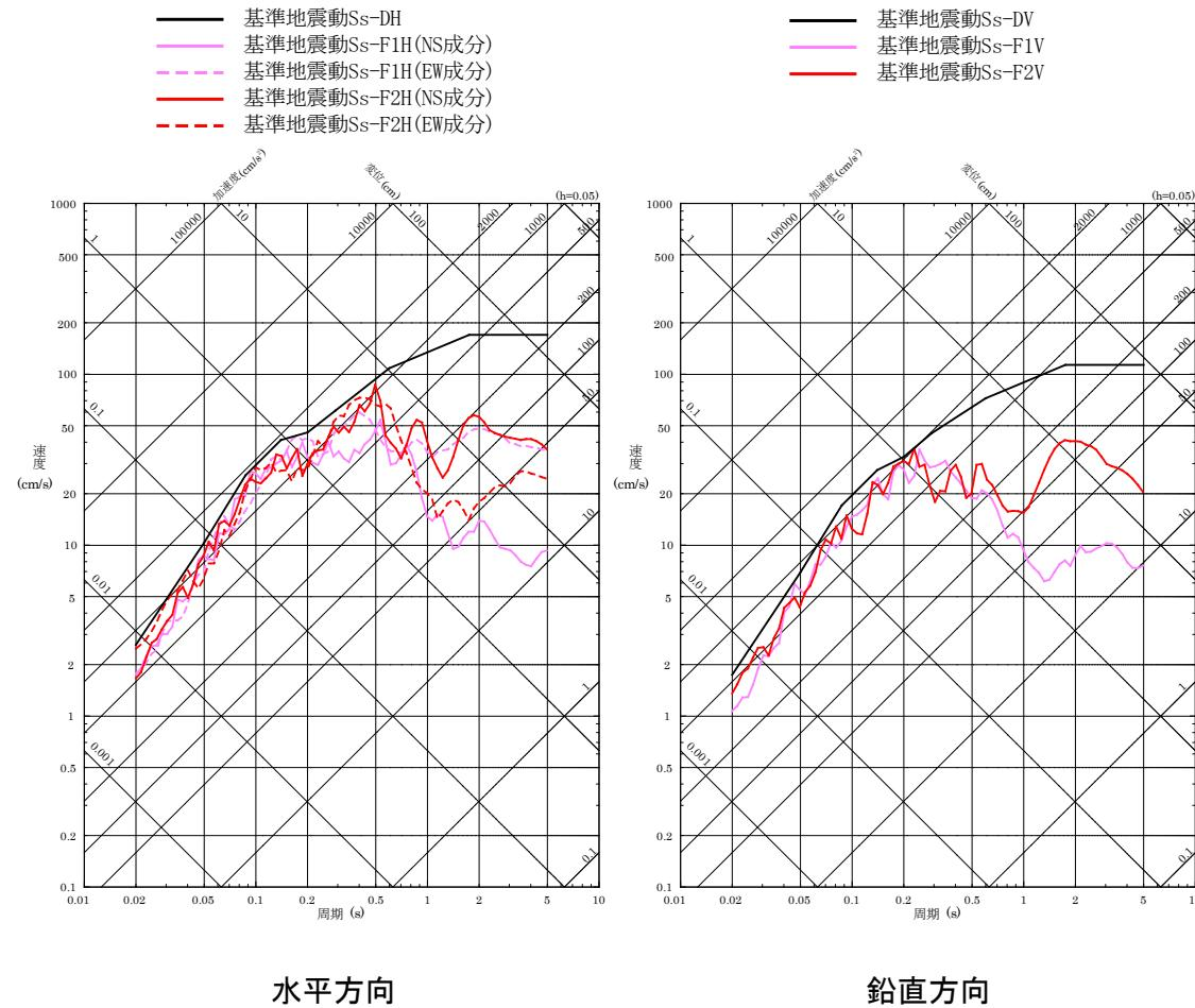
基準地震動Ss-F1及びSs-F2の擬似速度応答スペクトル
