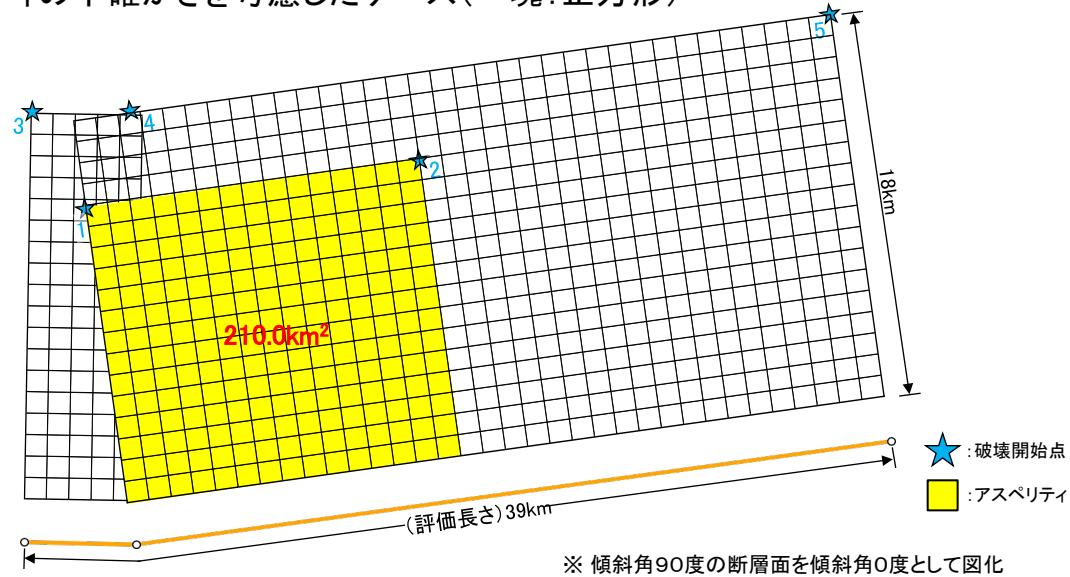
▶ 宍道断層による地震の断層モデル図:⑦アスペリティの不確かさを考慮したケース(一塊:縦長)
