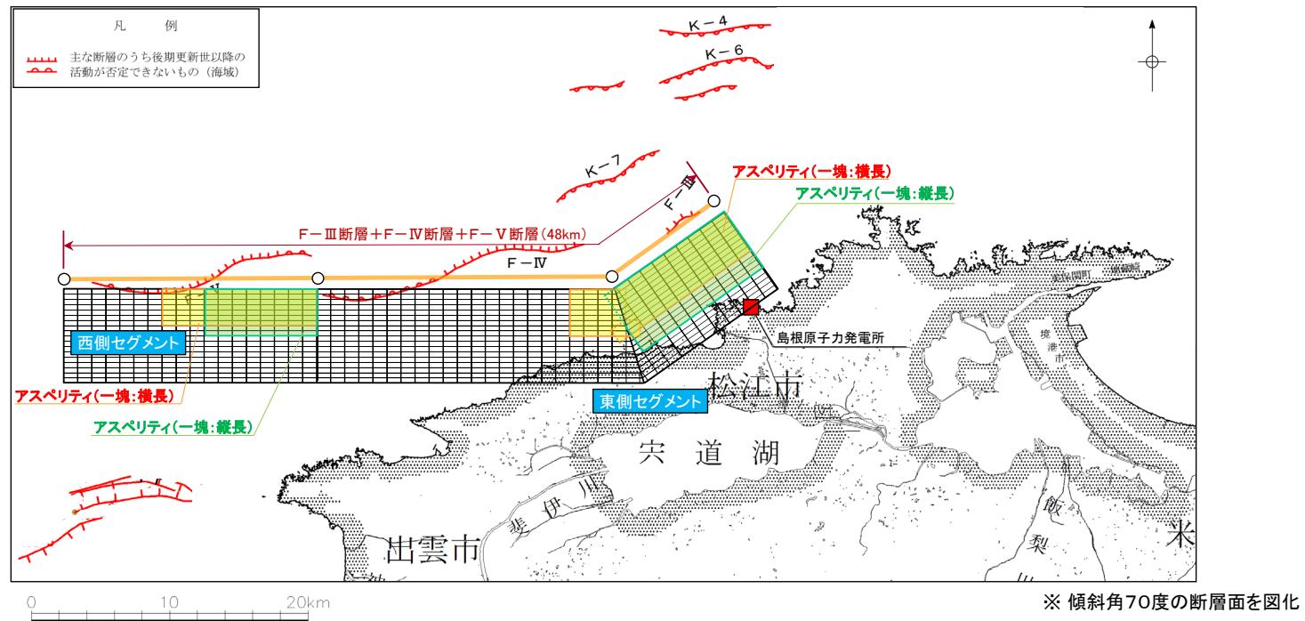
F-III断層+F-IV断層+F-V断層のアスペリティ配置と断層の評価区間の関係
