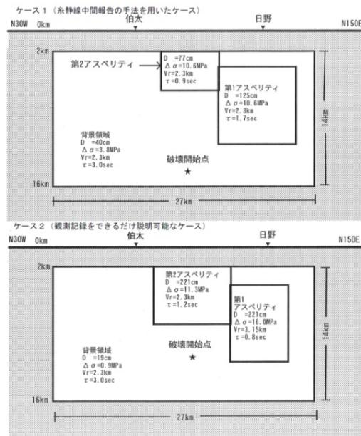
○震源断層の位置・長さ・幅・傾斜角・深さ・走向
