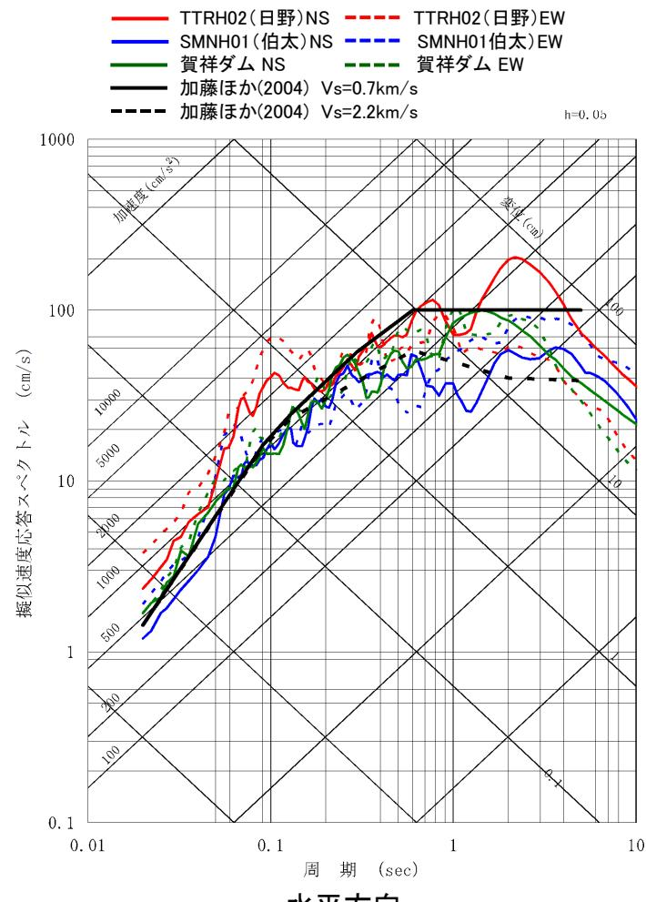
賀祥ダム(監査廊)等の観測記録の応答スペクトルと加藤ほか(2004)の応答スペクトルの比較
