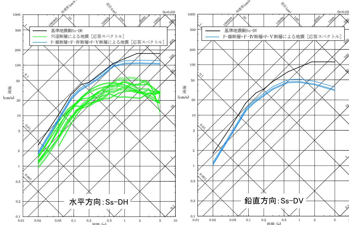
基準地震動Ss-D及び応答スペクトル手法による地震動評価結果の応答スペクトルの比較
