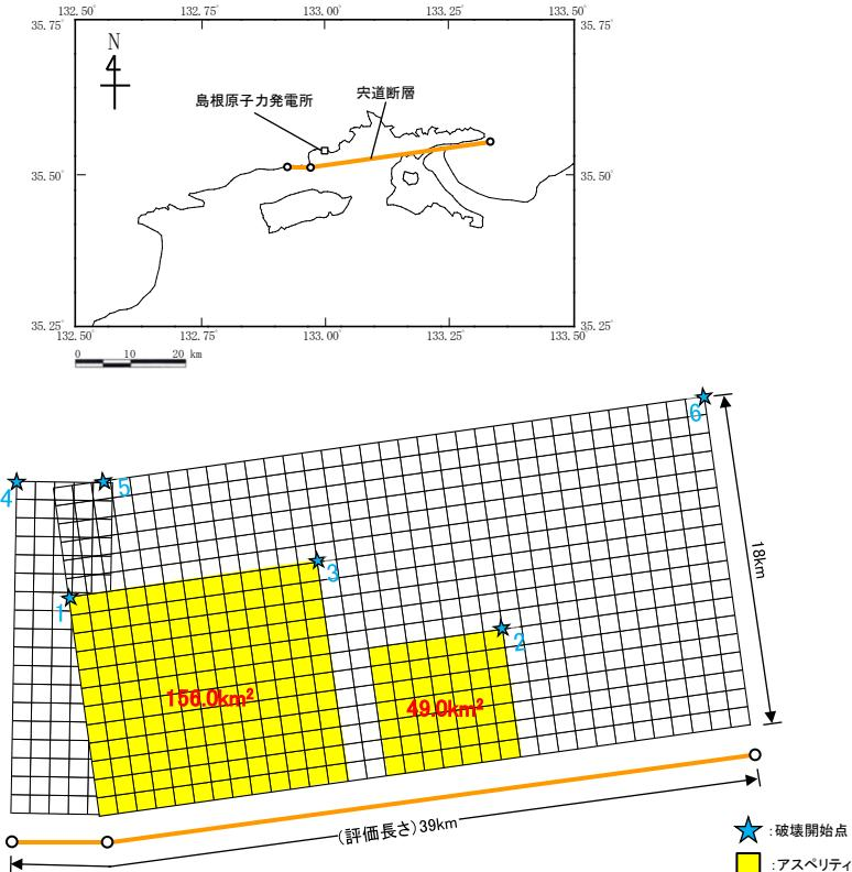
宍道断層による地震の断層モデル図(基本震源モデル)
