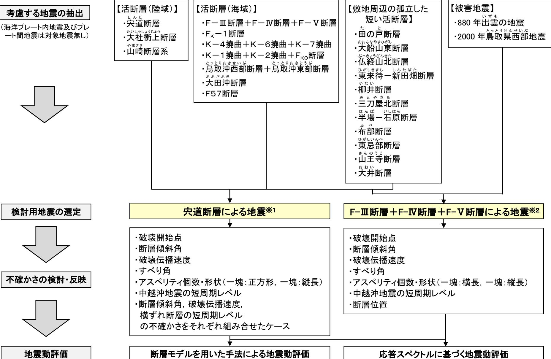
※1 耐専式の適用範囲外であるため、M-△の関係の比較に基づき選定(118ページ参照)
