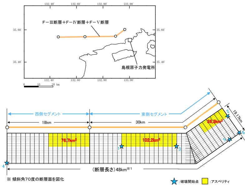
F-III断層+F-IV断層+F-V断層による地震の断層モデル図(基本震源モデル)
