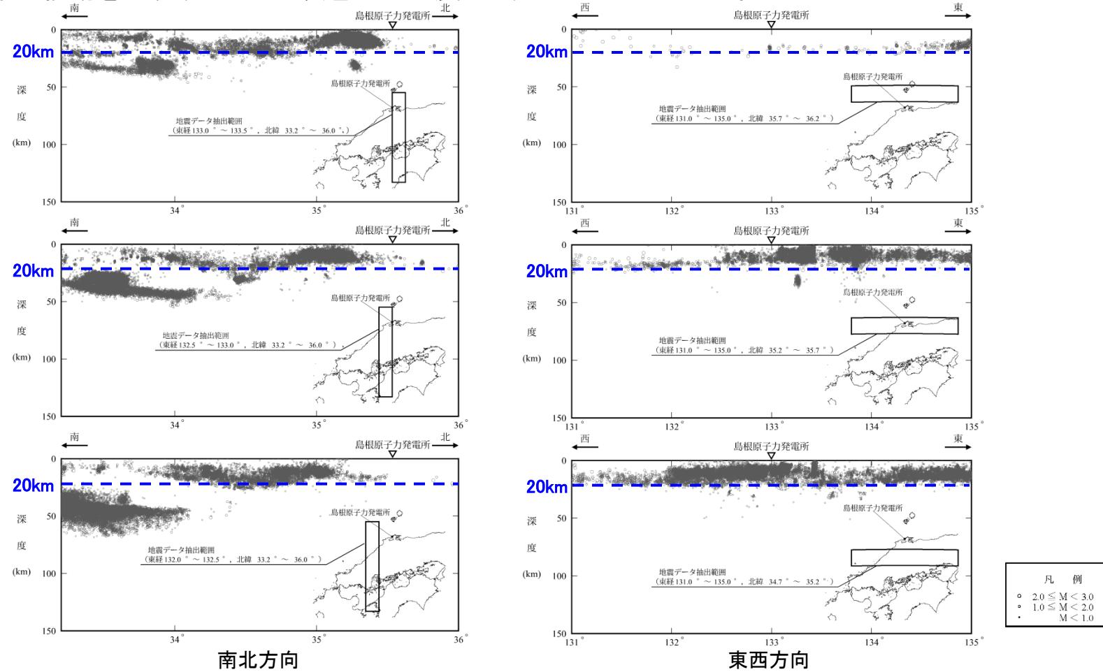
敷地周辺で発生した地震( $M < 3$ , 1997年10月～2019年8月)の震源鉛直分布 [地震諸元は「気象庁地震カタログ」による。]
