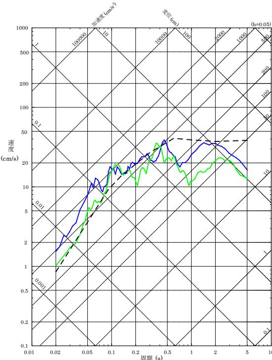
震源を特定せず策定する地震動の応答スペクトル
