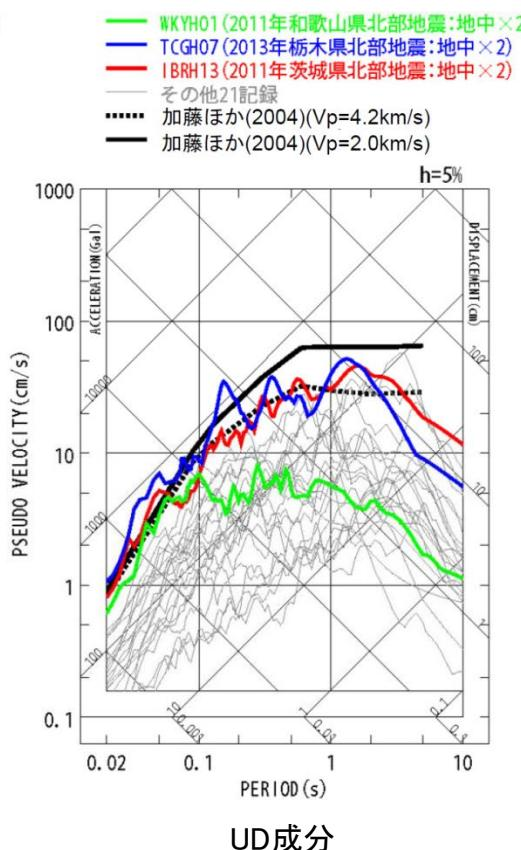
14地震の観測記録(地中×2)の応答スペクトルと加藤ほか(2004)の応答スペクトル
