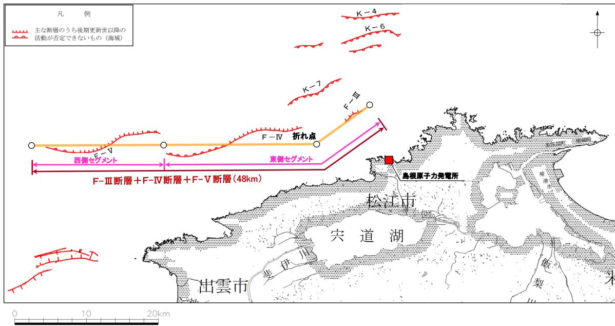
F-III断層+F-IV断層+F-V断層による地震の断層モデル
