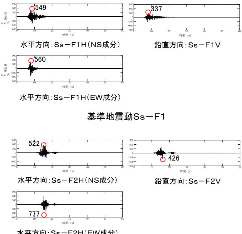
基準地震動Ss-F1及びSs-F2の加速度時刻歴波形
