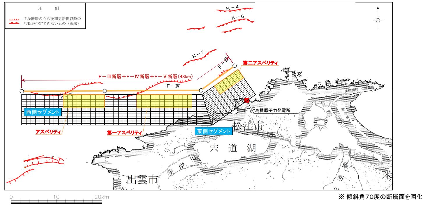
F-III断層+F-IV断層+F-V断層のアスペリティ配置と断層の評価区間の関係
