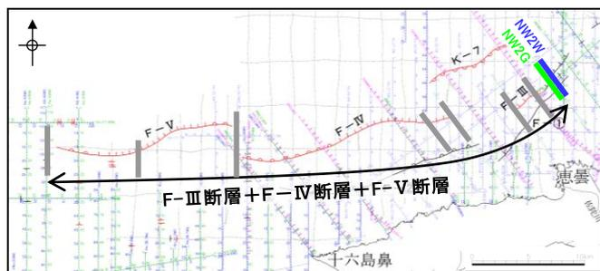
・F-III断層, F-IV断層及びF-V断層の東端にあたるF-III断層は, D<sub>2</sub>層に変位, D<sub>1</sub>層及びC層に変形が認められるが, B<sub>2E</sub>層以上に断層活動を示唆する変位や変形は認められない。
