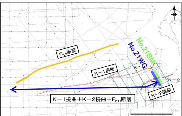
・K-1撓曲, K-2撓曲及びF<sub>KO</sub>断層の東端部にあたるK-2撓曲は, B<sub>2w</sub>層まで変形が認められるが, B<sub>1w</sub>層以上に断層活動を示唆する変位や変形は認められない。
