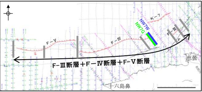
・F-Ⅳ断層東方延長部付近では、C層及びD<sub>1</sub>層上面において反射面が連続し、B<sub>1E</sub>層以上に断層活動を示唆する変位や変形は認められない。
