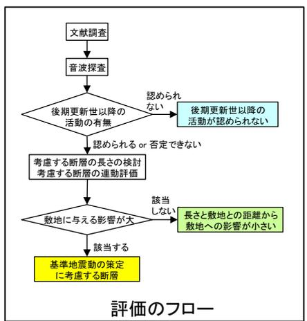
敷地周辺海域において断層の長さや敷地までの距離を考慮した結果、敷地に与える影響が高いものとして、「鳥取沖西部断層+鳥取沖東部断層(約98km)」、「大田沖断層(約53km)」、「F57断層(約108km)」及び「K-1撓曲+K-2撓曲+F<sub>KO</sub>断層(約36km)」を基準地震動の策定に考慮するものとした。
