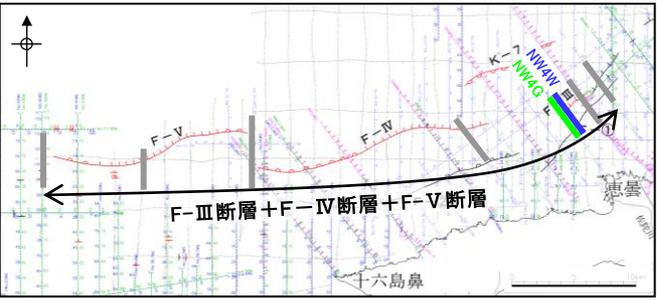
・F-Ⅲ断層西方延長部付近では、C層、D<sub>1</sub>層及びD<sub>2</sub>層上面において反射面が連続し、断層活動を示唆する変位や変形は認められない。
