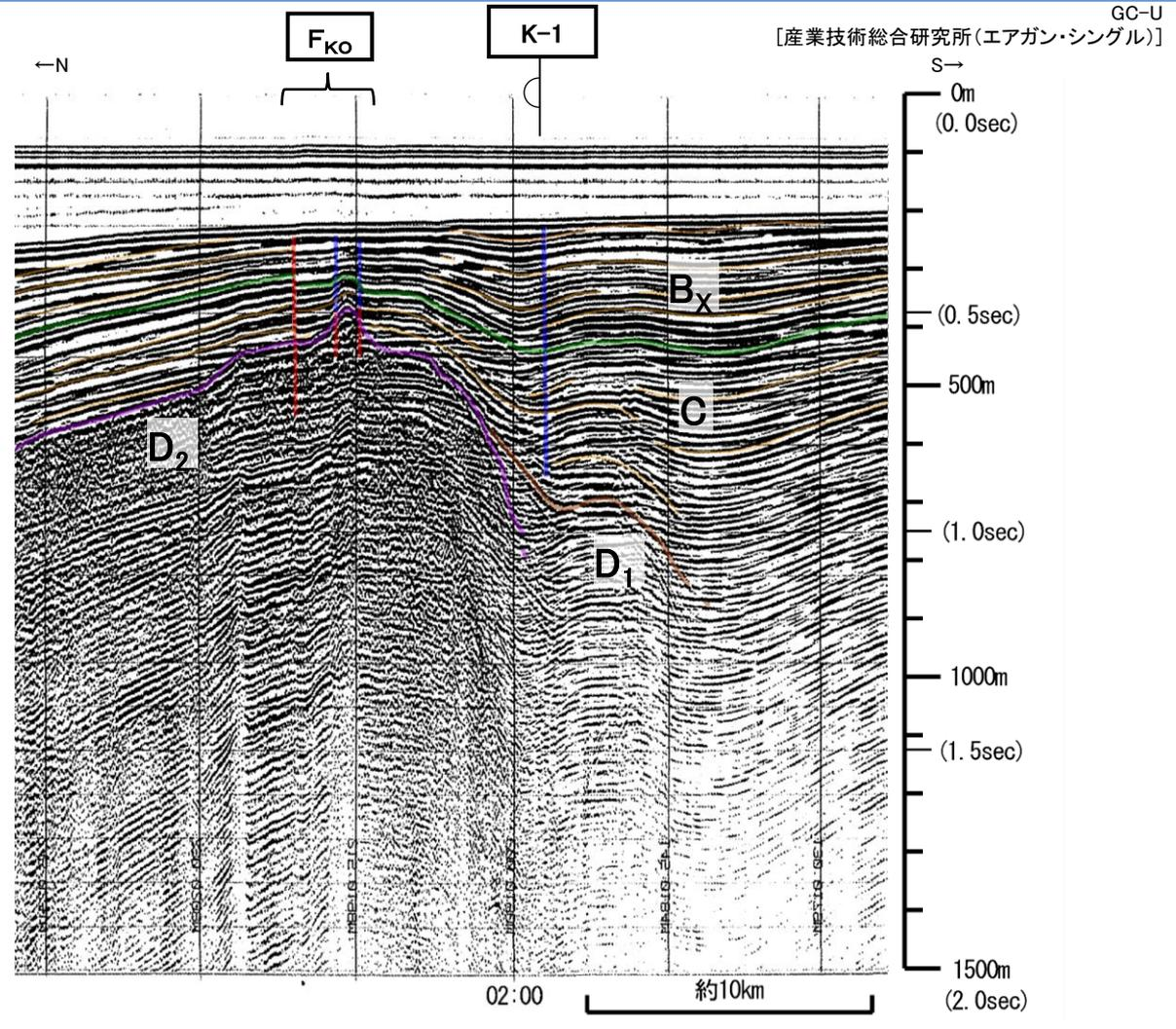
・F<sub>KO</sub>断層は、D<sub>2</sub>層の高まりの頂部に位置し、D<sub>2</sub>層上面以上に明瞭な変位や変形が認められ、正のフラワーストラクチャーを示す。
