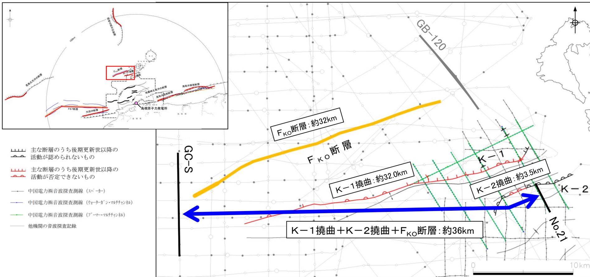
・K-1 撓曲及びK-2 撓曲は、敷地前面海域北部に位置する2条の複背斜構造の北縁を形成する、東北東-西南西方向の走向、北落ちの断層であり、地質構造上の類似性が認められ、撓曲間の距離が近いことから、連動するものとして評価した。
