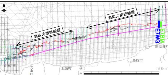
・鳥取沖西部断層及び鳥取沖東部断層の東端にあたるK1撓曲東方延長部において、C層以上に断層活動を示唆する変位や変形は認められない。
