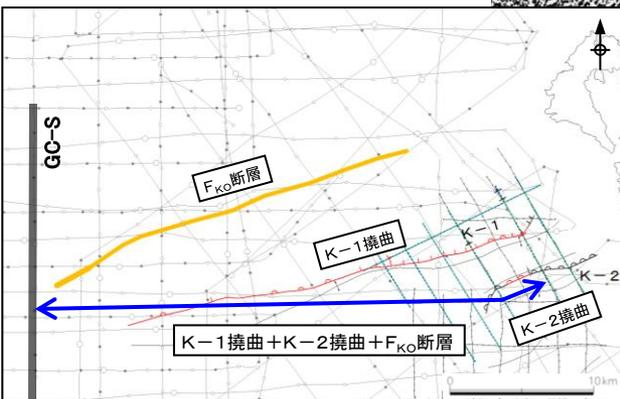
・K-1撓曲, K-2撓曲及び $F_{KO}$ 断層の西端部にあたる $F_{KO}$ 断層西方延長部において,  $D_2$ 層上面以上の明瞭な変位やフラワーストラクチャーは見られず, 断層活動を示唆する変位や変形は認められない。
