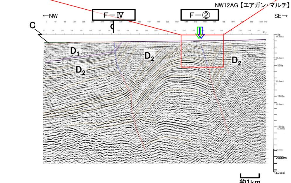
・F-②断層はD<sub>2</sub>層下部に変位が、D<sub>2</sub>層上部に変形が認められるが、D<sub>2</sub>層最上部は緩やかに褶曲しており、断層活動を示唆する変位や変形は認められない。また、ブーマー記録において、B<sub>1E</sub>層以上に断層活動を示唆する変位や変形は認められない。
