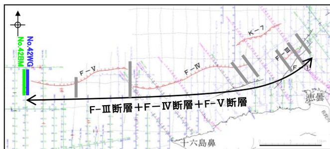
・F-Ⅲ断層, F-Ⅳ断層及びF-V断層の西端にあたるF-V断層西方延長部において, 断層活動を示唆する変位や変形は認められない。
