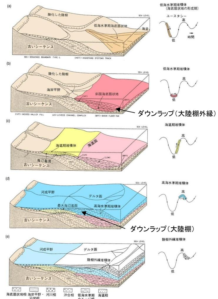
第6図、低海水準期 (a, b), 海進期 (c), 高海水準期 (d), 大陸棚外縁堆積体 (e) の特徴およびユースタシーのどの段階で形成されるかを簡単に図示したもの (Haq, 1991)。
