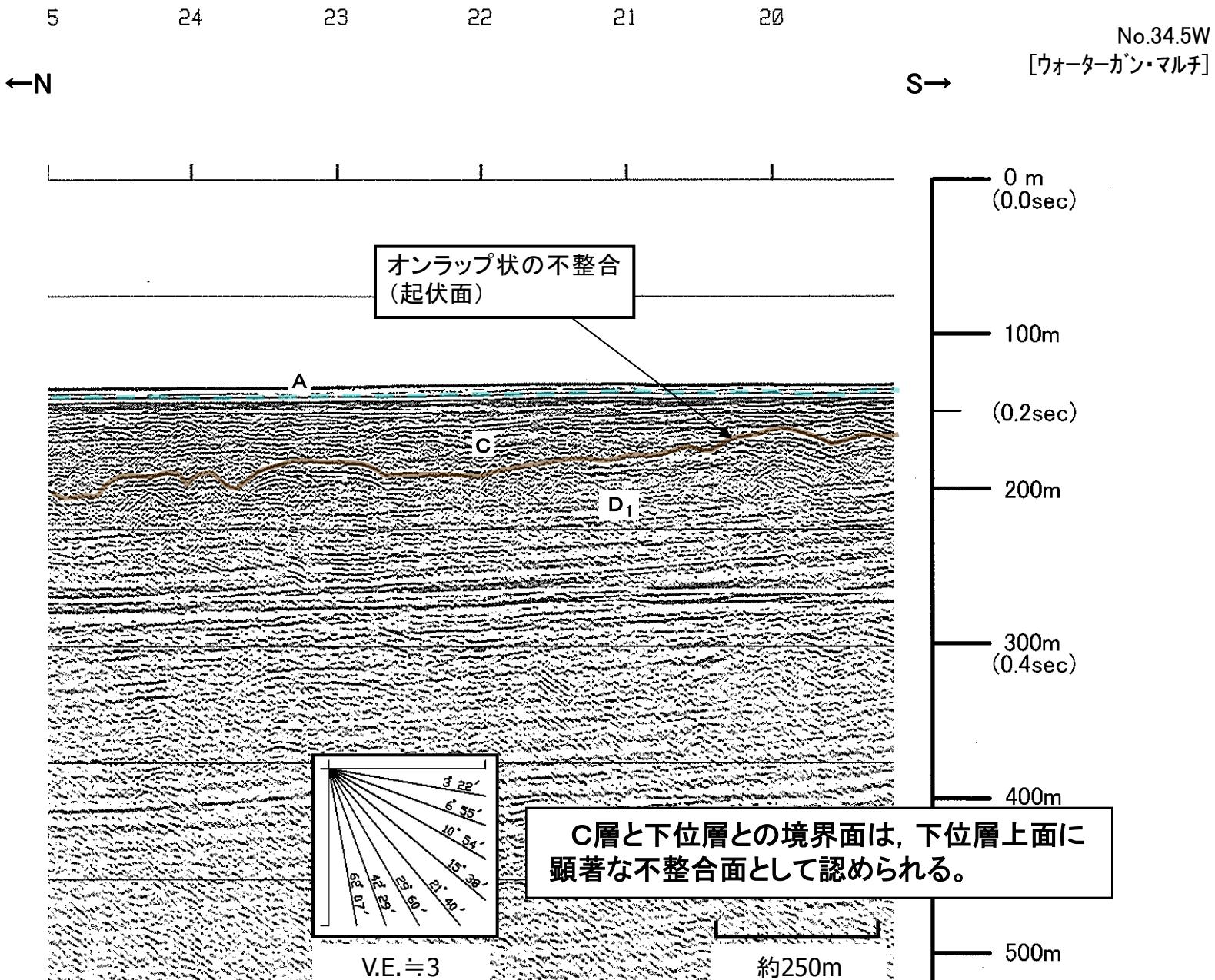
D<sub>1</sub>層とD<sub>2</sub>層の不整合面(音波探査記録例)
