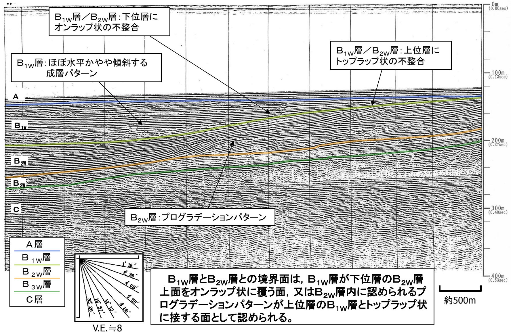
B<sub>1W</sub>層とB<sub>2W</sub>層の不整合面の分布(北西部海域)
