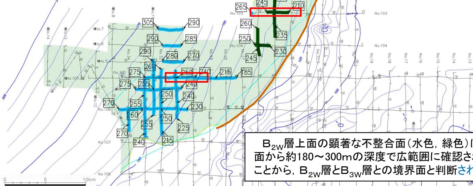
B<sub>2W</sub>層上面の顕著な不整合面(水色, 緑色)は海面から約180~300mの深度で広範囲に確認されることから、B<sub>2W</sub>層とB<sub>3W</sub>層との境界面と判断される。
