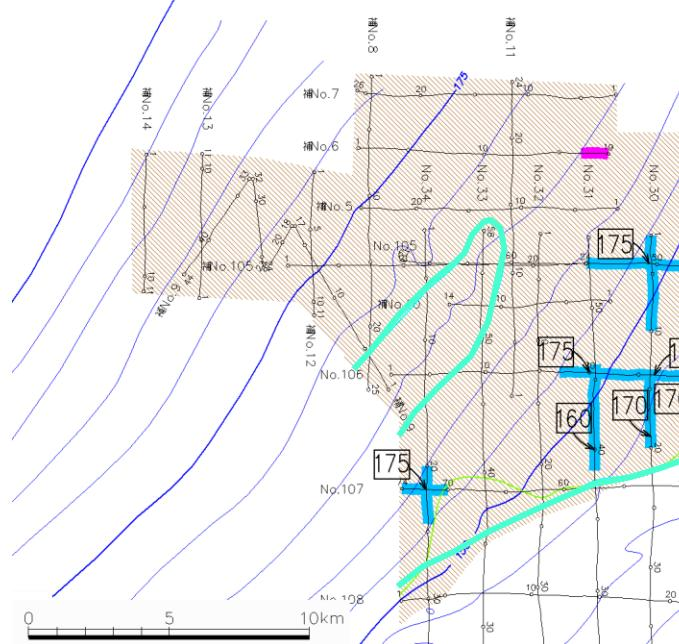
B<sub>2W</sub>層上面の顕著な不整合面(水色, ピンク色)は海面から約150~200mの深度で広範囲に確認されることから、B<sub>1W</sub>層とB<sub>2W</sub>層との境界面と判断される。
