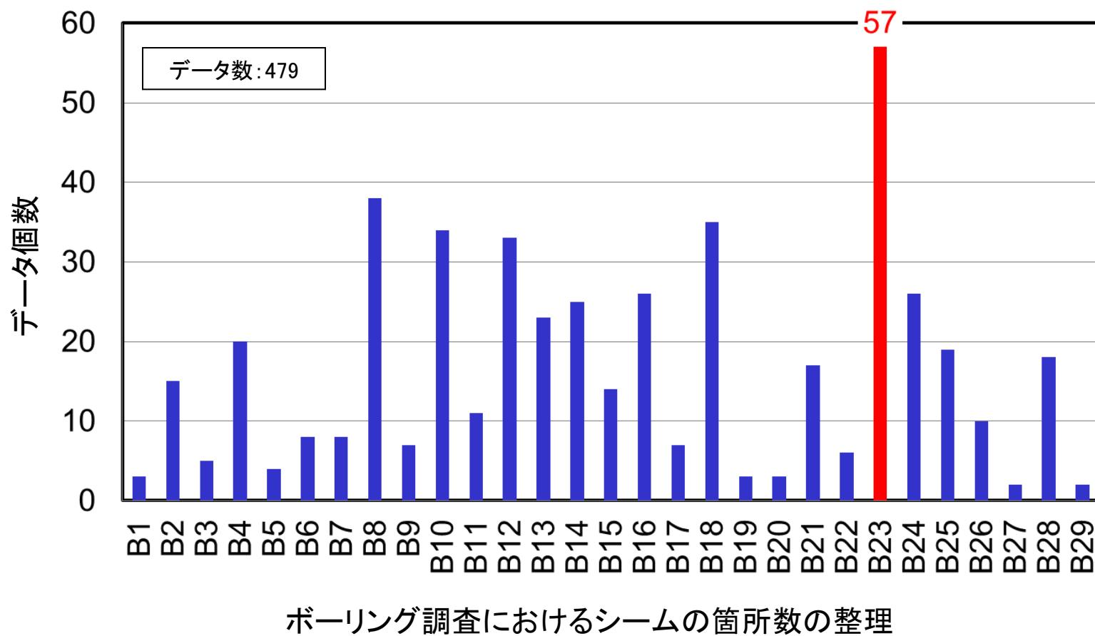
・データの豊富な3号炉のボーリング調査により、シームの確認箇所数を整理した結果、B23シームが最も多く確認されていることから、B1～B29シームのうち最も連続性が高いシームであると評価した。（補足説明3.（2）①を参照）
