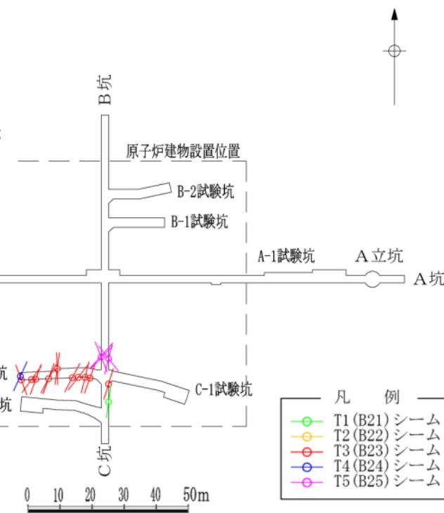
・試掘坑内でのシームの条線方向調査の結果、シームの最終変位方向は、概ね南北方向である。
