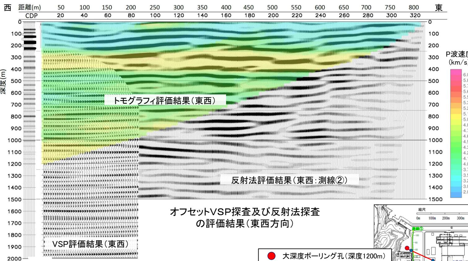
オフセットVSP探査及び反射法探査
