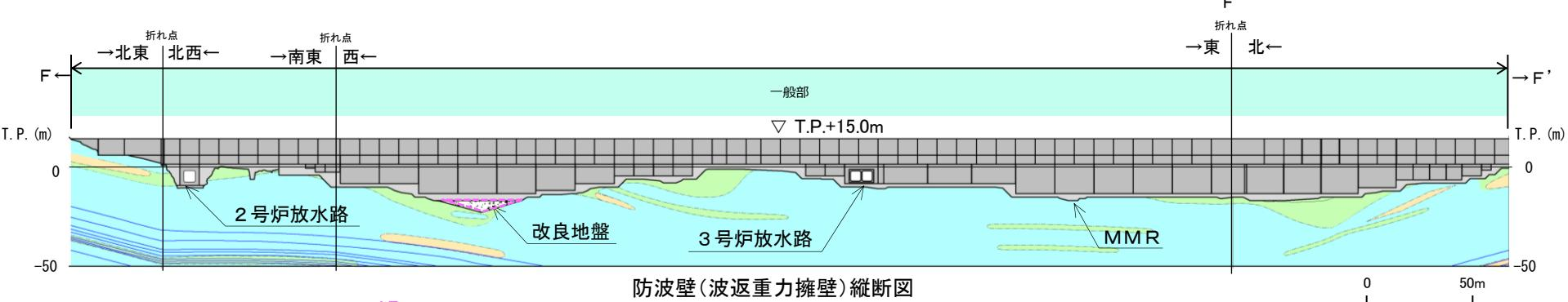
※1 図中の [ ] については、地盤改良を実施しているが、元の砂礫層の分布を示すために、改良前の地質状況を示している。
