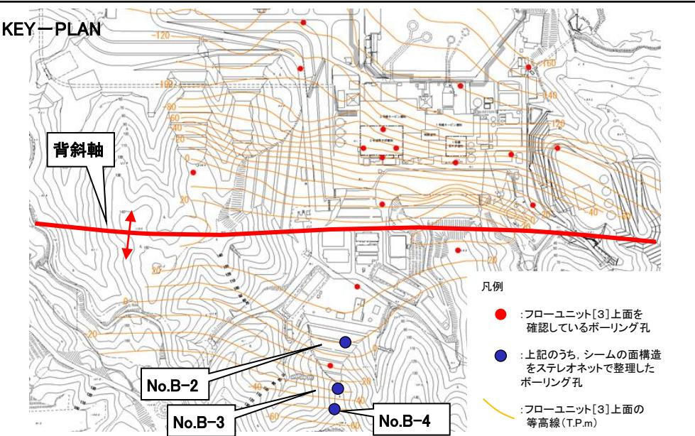
・背斜軸の南側に分布するシームは、地層の走向・傾斜と同様に、ほぼ東西走向で緩やかな南傾斜を示す。(背斜軸とシーム層厚との関係を補足説明2章に示す)
