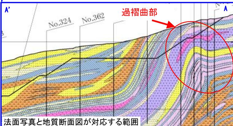
※背斜軸付近の地質構造を示すため、旧地形の平面図及び断面図を示す。
