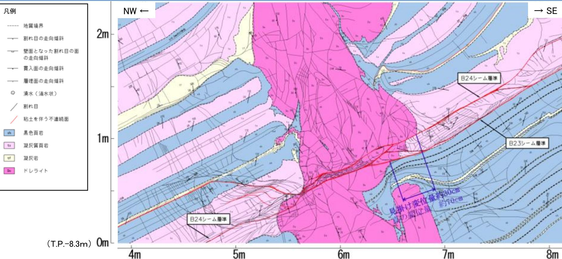
※ シームの想定変位量は、試掘坑壁上の見かけで最大30cm程度であり、観察位置での岩脈の貫入方向(N48° E)と条線方向(N22° E)を加味して算出した真の変位量で最大約70cmである。
