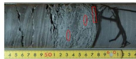
・B23シームで確認された方解石の生成温度を推定するため、既往ボーリングコアのシームの周辺母岩の白色脈から試料を採取し、流体包有物試験及び酸素同位体試験を実施した。
