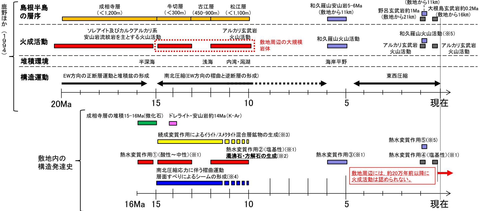
・B23シームの薄片観察結果、流体包有物試験による方解石の生成環境の検討、敷地近傍における火成活動等を踏まえ、熱水変質鉱物である濁沸石・方解石は、後期更新世以降に生成されたものではないと評価した。
