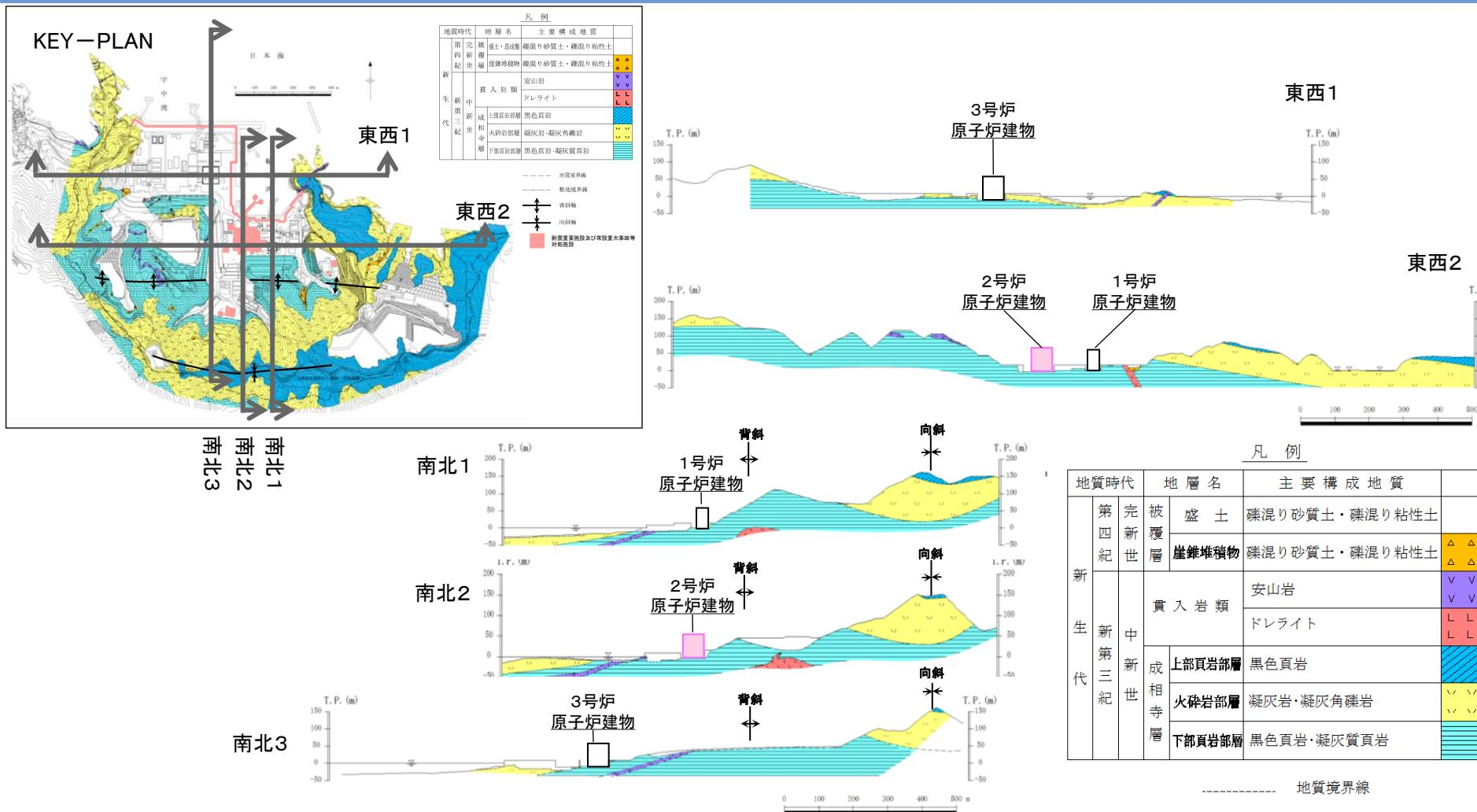
※敷地の地質・地質構造を示すため、旧地形の断面図を示す。
