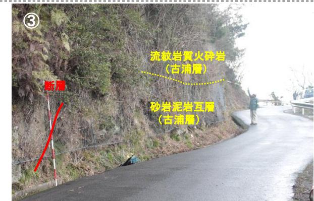
・古浦層の流紋岩質火碎岩と砂岩泥岩互層を境する断層(N46E/60N)である。
