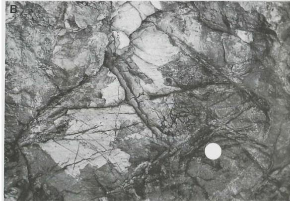
図IX.3-11 水圧破碎による不規則な角礫状破碎組織
