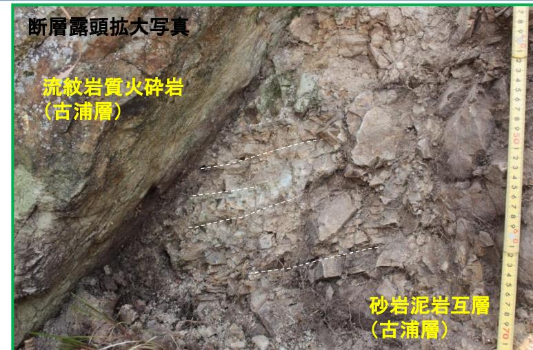
・断層面沿いに風化は進むが、面は密着しており、破碎は認められない。また、古浦層中の砂岩泥岩互層中の層理面の走向傾斜の乱れが認められない。
