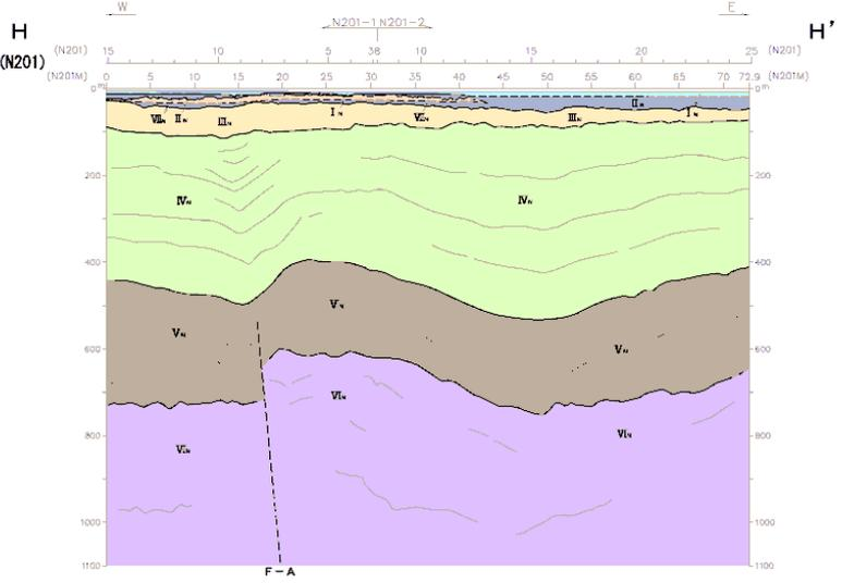
F-A断層は、下部～中部中新統(V<sub>N</sub>～VI<sub>N</sub>層)に変位が認められるが、中部～上部中新統(III<sub>N</sub>～IV<sub>N</sub>層)、中部～上部更新統(II<sub>N</sub>層)及び完新統(I<sub>N</sub>層)に変位や変形を与えていない。
