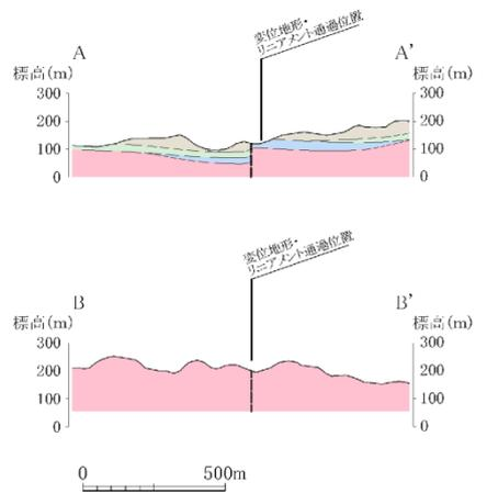
三刀屋北断層周辺の地質図及び地質断面図
