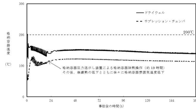
第2図 格納容器雰囲気温度
