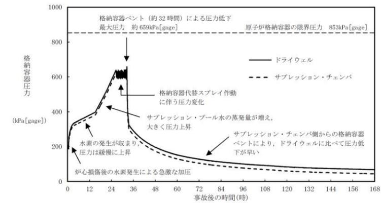
第2図 ベント時の格納容器圧力推移
