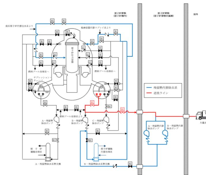
第6図 残熱除去系吸入ストレーナ逆洗操作の系統構成について
