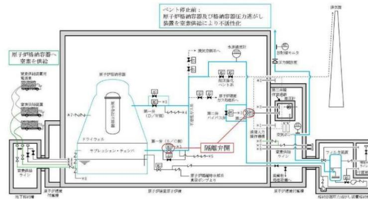
第7図 窒素供給概要図 (ベント停止前)
