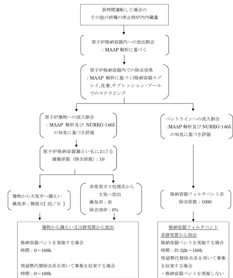
※非常用ガス処理系の定格風量 4400m<sup>3</sup>/h による換気率 1 回/日により屋外に放出
