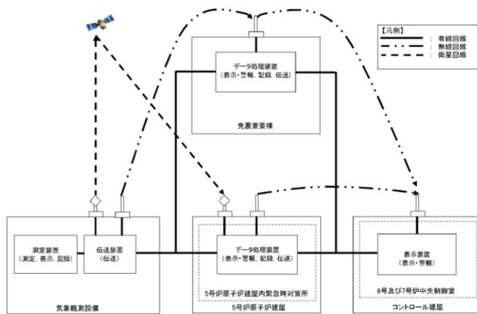
図 2.1-2 気象観測設備の伝送概略図
