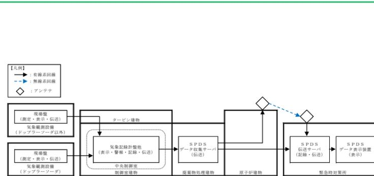
第 2.1-2 図 気象観測設備の伝送概略図
