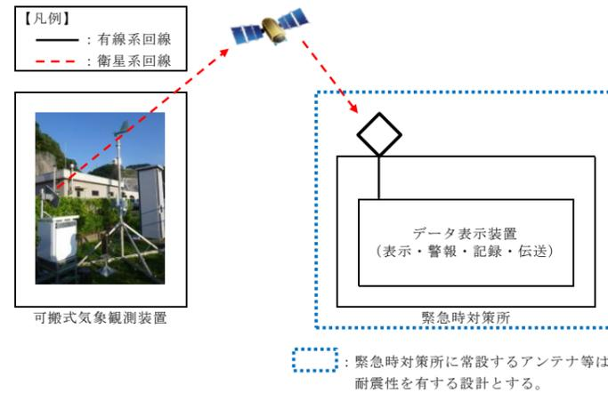
第 2.2-2 図 可搬式気象観測装置の伝送概略図
