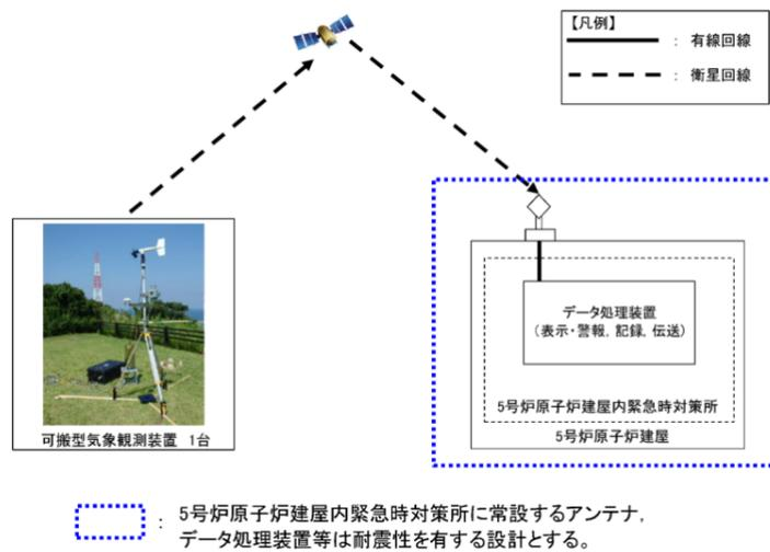
図 2.2-2 可搬型気象観測装置の伝送概略図
