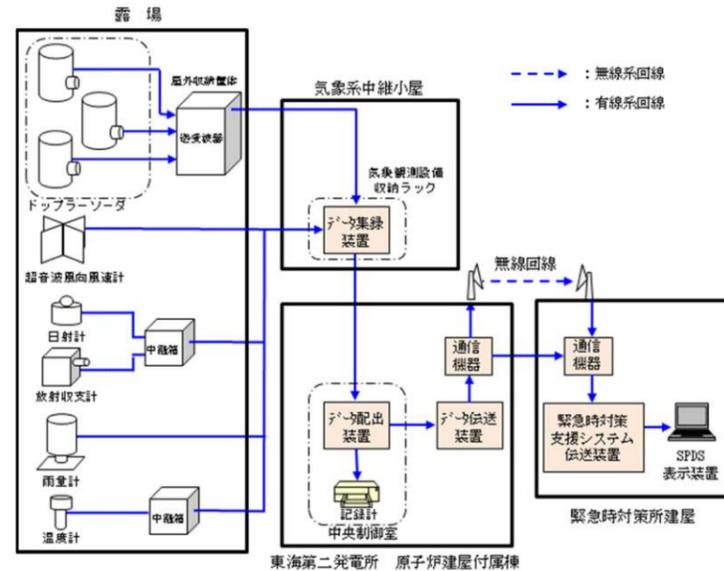
第 2.1-2 図 気象観測設備の伝送概略図
