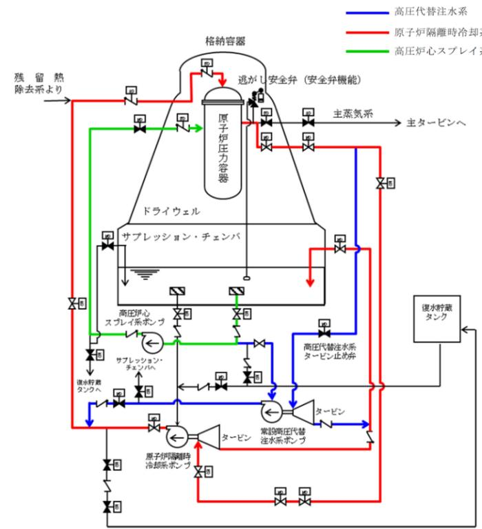
第4-1図 高压代替注水系，原子炉隔離時冷却系
