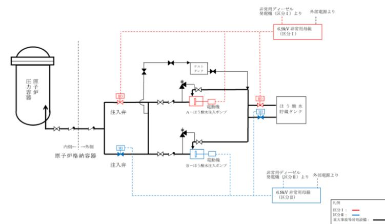
第4 図 ほう酸水注入系の概要図
