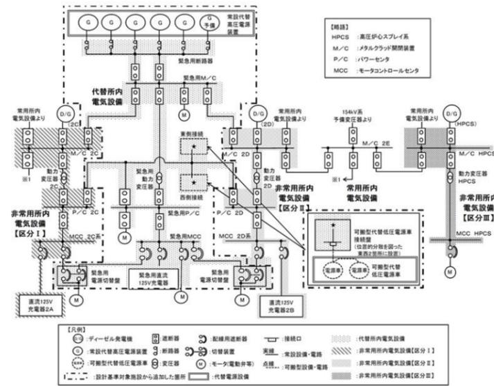
第6-3 図 電源構成図 (交流電源) (1/2)
