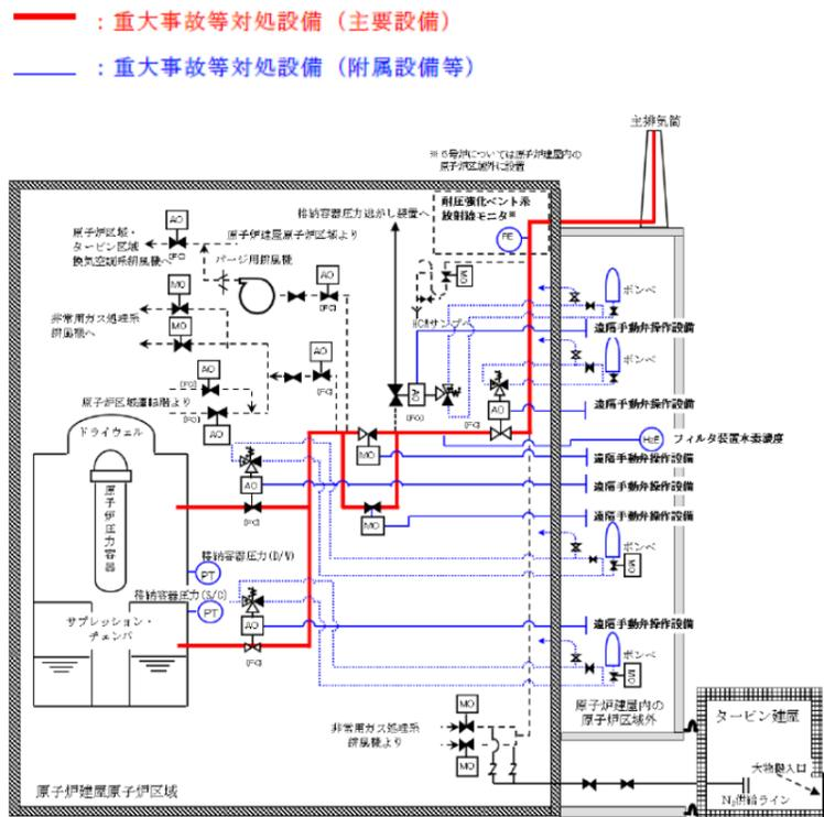
第18 図：耐圧強化ベント系 系統概要図
