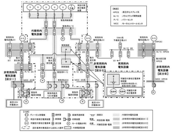
第8-7 図 電源構成図 (交流電源) (1/2)
