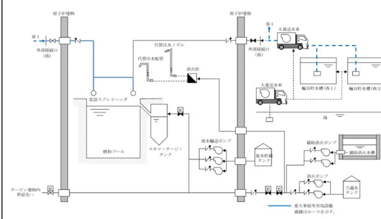
第41-1図 燃料プールスプレイ系（常設スプレイヘッダによる）の系統概略図
