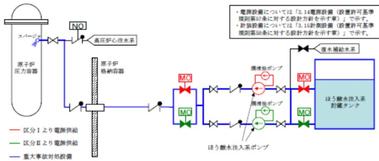
第6 図：ほう酸水注入系の概要図
