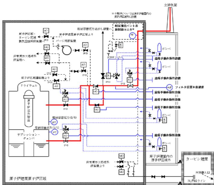
第45 図 : 耐圧強化ベント系 系統概略図
