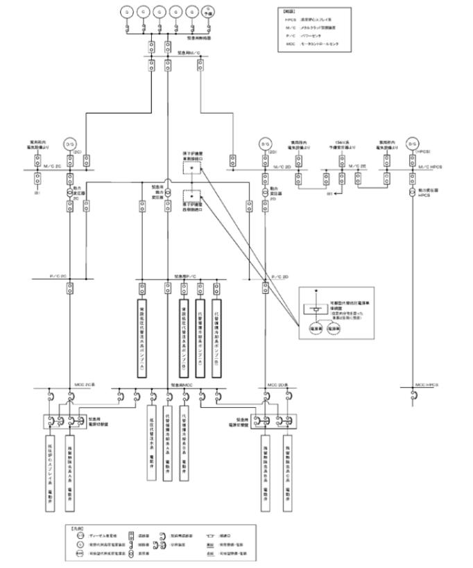
第8-8 図 電源構成図 (交流電源) (2/2)
