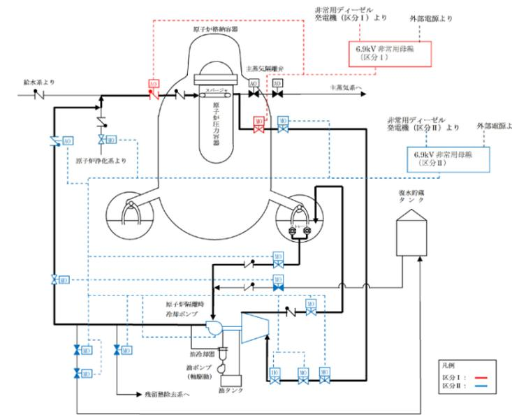
第6-2 図 原子炉隔離時冷却系 系統概略図
