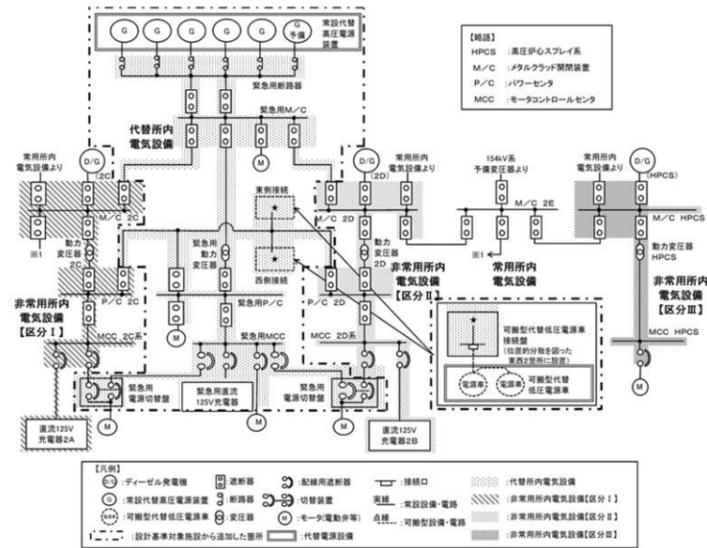
第7-3 図 電源構成図 (交流電源) (1/2)
