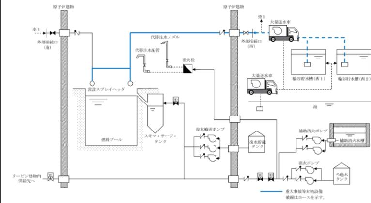
第23-1 図 燃料プールスプレィ系（常設スプレィヘッドによるスプレィの場合）の系統概略図
