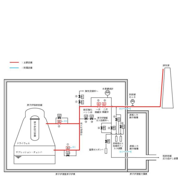
第8-1図 耐圧強化ベント系 系統概要図
