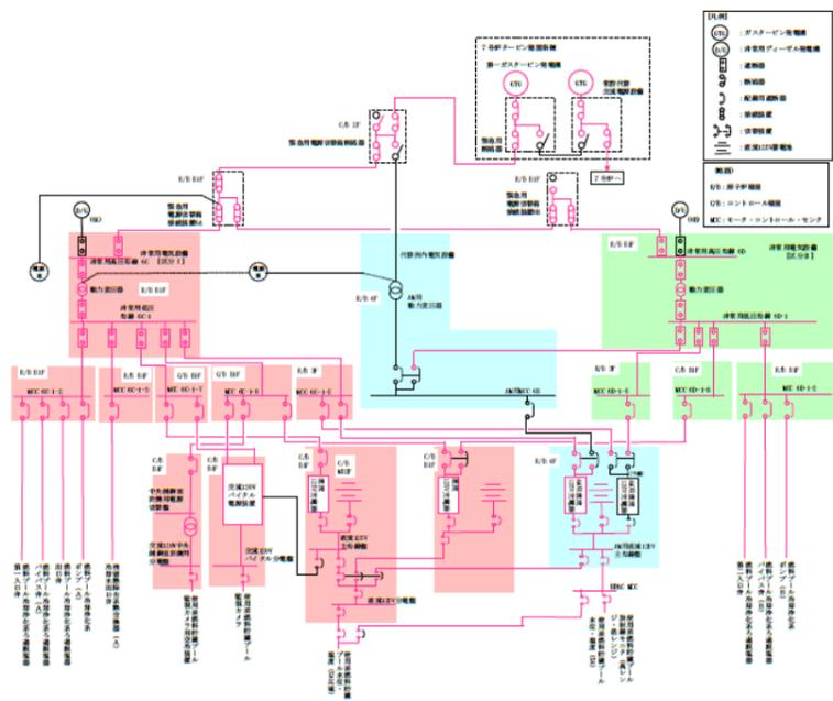
第32-1 図：単線結線図 (6号炉)
