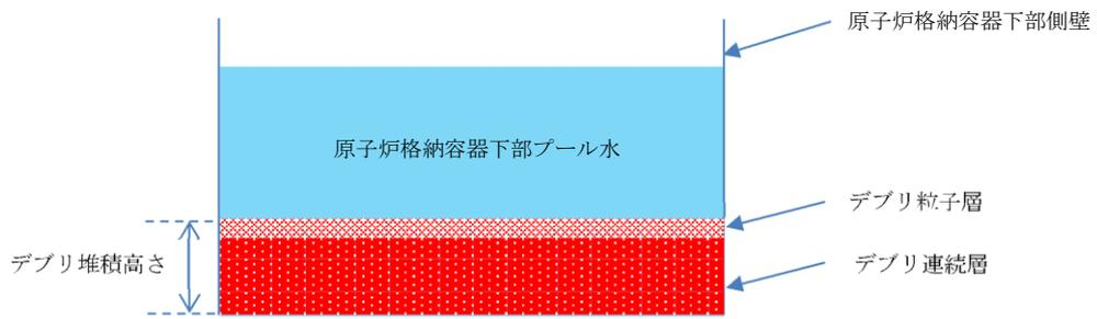
図3 デブリ堆積高さの概念図
