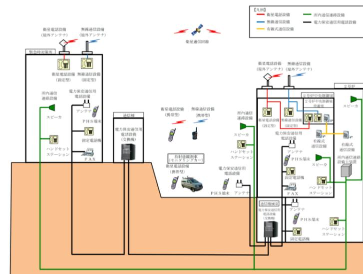
第2.2-1図 通信連絡設備（発電所内）の概要
