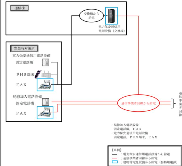
参考第4-1図 局線加入電話設備の構成
