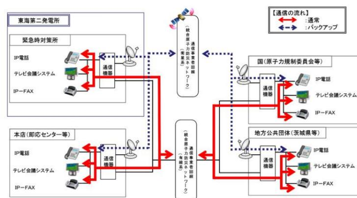
第2.3-3図 通信設備（発電所外〔社外関係箇所〕）の概要
