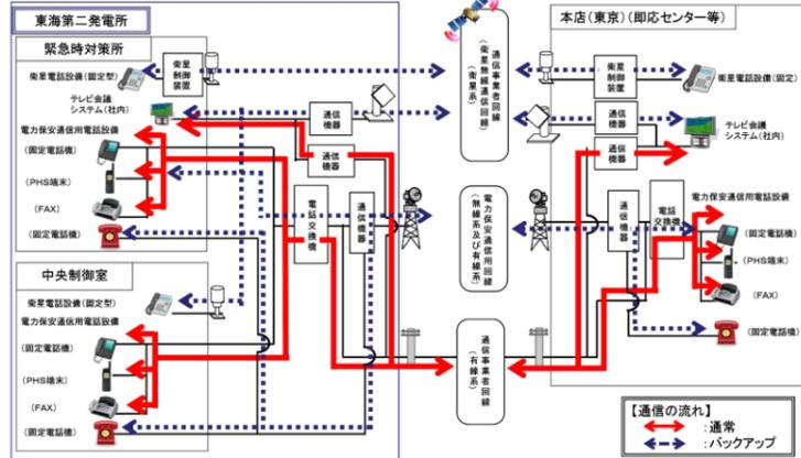
第2.3-1図 通信設備（発電所外〔社内関係箇所〕）の概要
