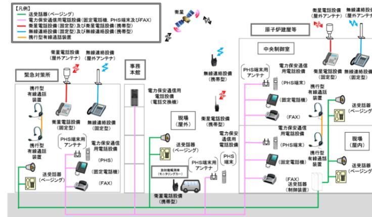
第2.2-1図 通信設備（発電所内）の概要
