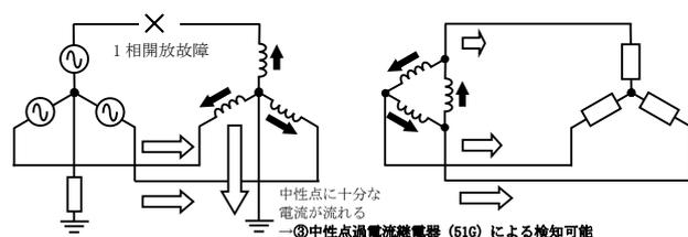
第 2.2.1-9 図 ③中性点過電流継電器（51G）による検知（イメージ）
