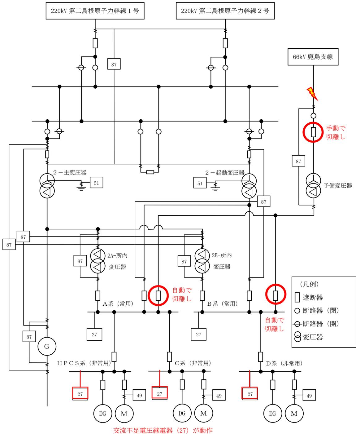
第 7-3 図 故障箇所を隔離した状態
