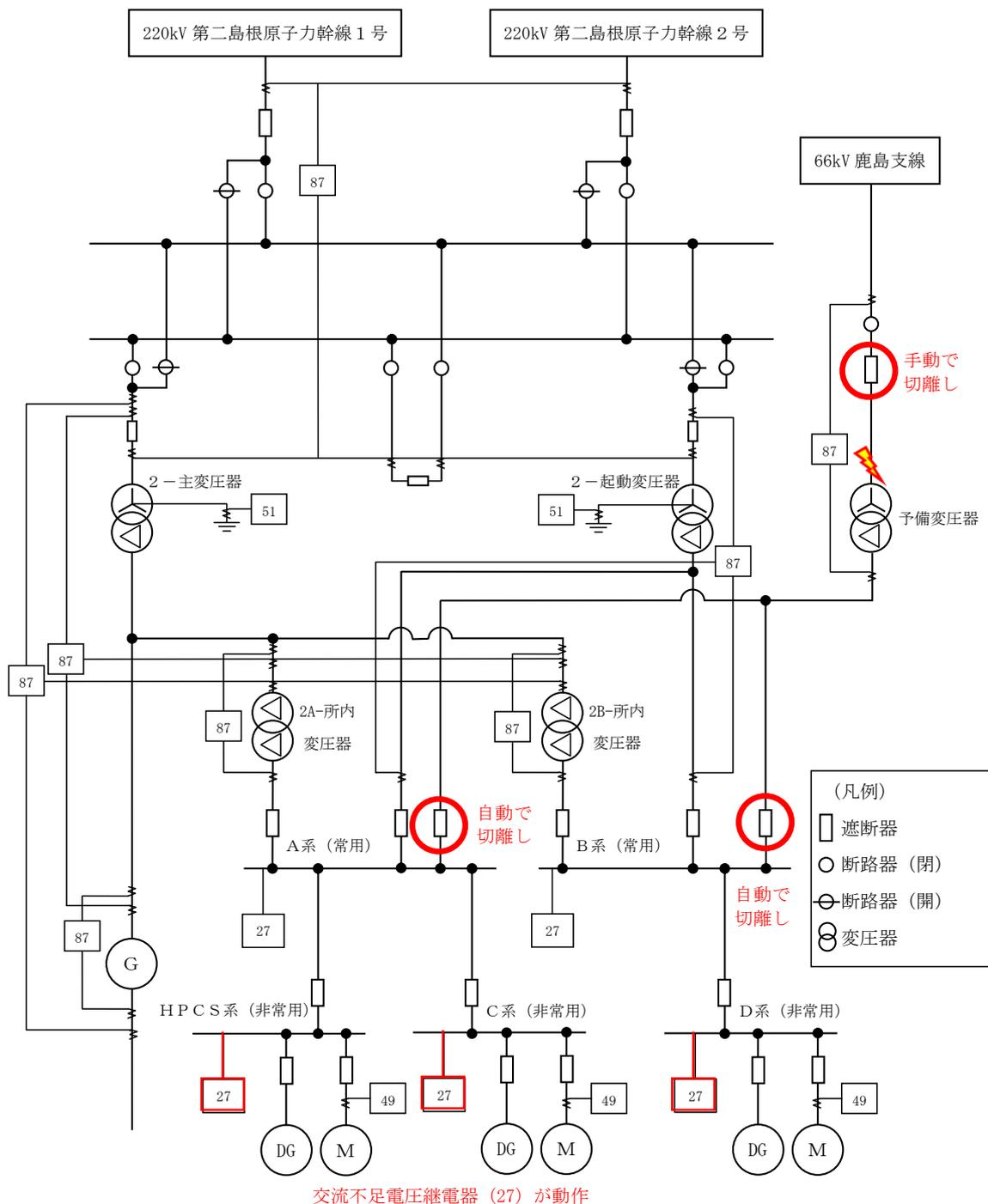
第 9-3 図 故障箇所を隔離した状態
