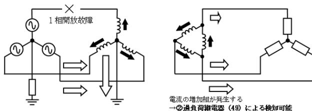
第 2.2.1-10 図 ②過負荷継電器（49）による検知（イメージ）
