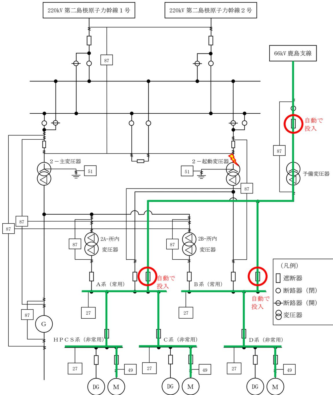
第 6-4 図 非常用高压母線へ電源供給した状態
