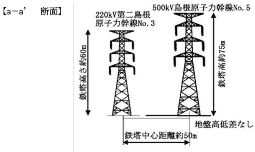
第 2. 2. 3-3 図 近接箇所の詳細【a-a' 断面】
