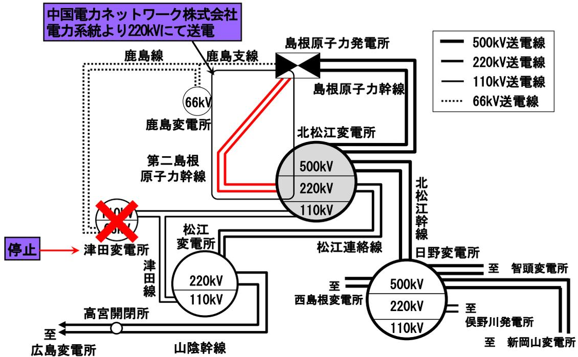
第 2.2.2-7 図 津田変電所全停時の供給系統
