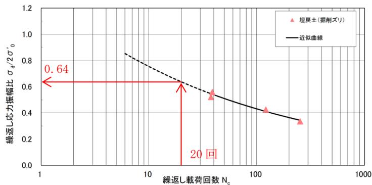
第2.2.4-26図 液状化試験結果
