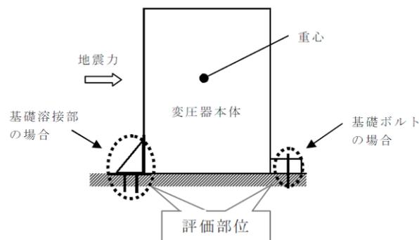
第 2. 2. 4-8 図 変圧器の概要図
