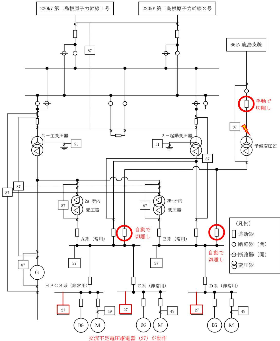
第 10-3 図 故障箇所を隔離した状態
