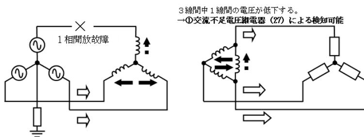
第 2. 2. 1-12 図 ①交流不足電圧継電器 (27) による検知 (イメージ)
