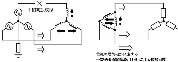
第 2. 2. 1-11 図 ②過負荷継電器 (49) による検知 (イメージ)
