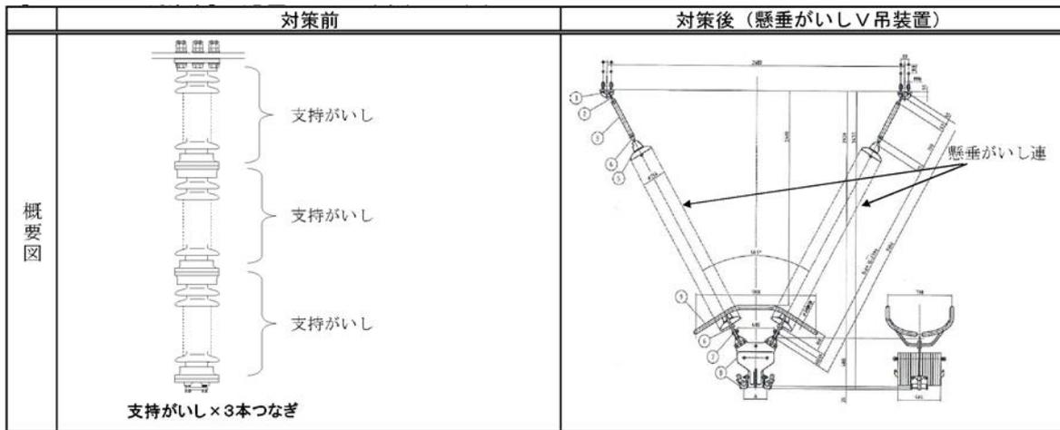
【66kV の対策】（支持碍子へ免震装置を取付）
