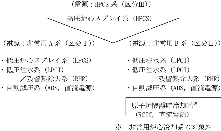
第 1-1 図 非常用炉心冷却系の系統構成
