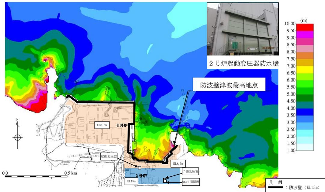
第 2.2.4-28 図 施設護岸最大水位上昇分布図
