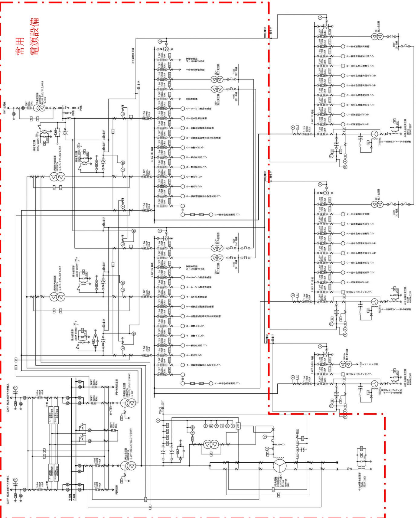
第 2.1.1-3 图 交流電源単線結線図 (常用所内電源設備)
