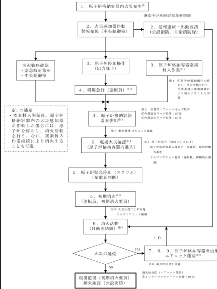
第3-2 図 原子炉格納容器内での火災発生に対する対応フロー
