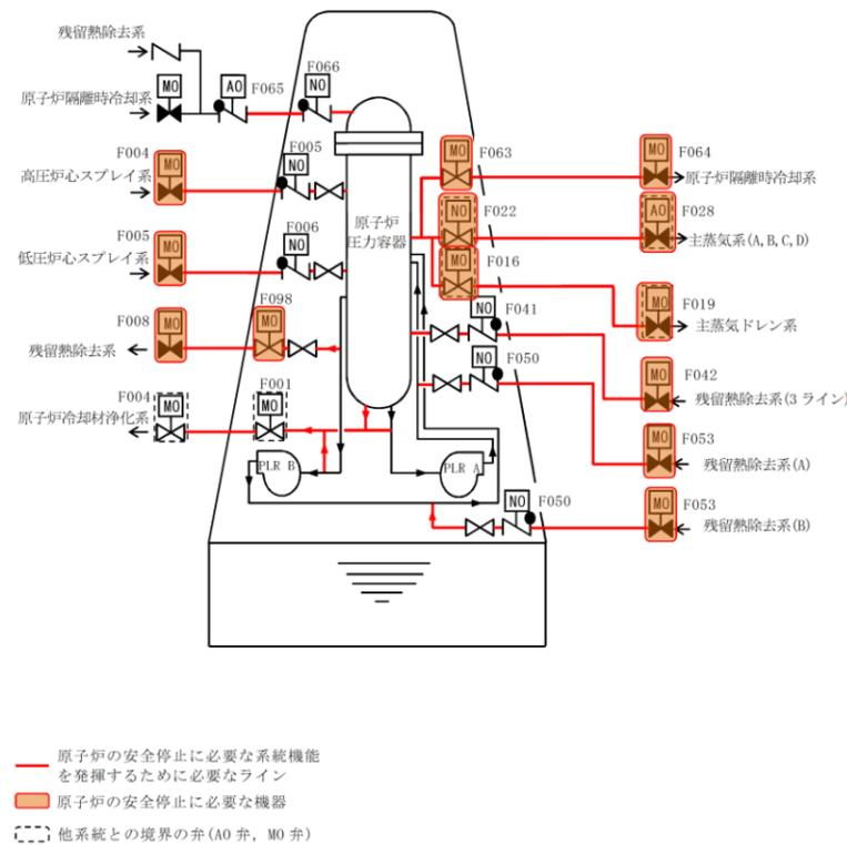
第 1 図 原子炉冷却材圧力バウンダリ
