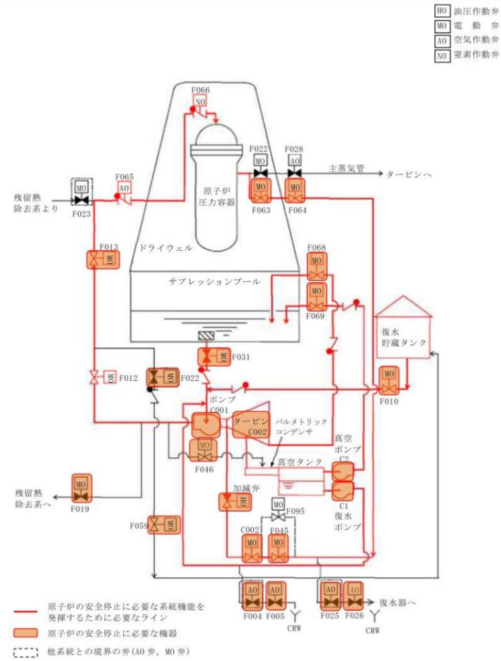
第5図 原子炉隔離時冷却系
