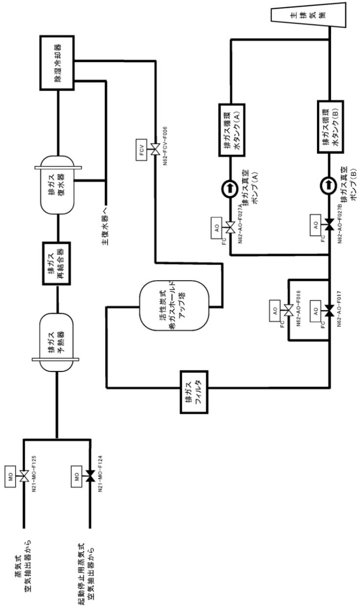
図 9-2 : 気体廃棄物処理系 系統概要図 (7号炉)
