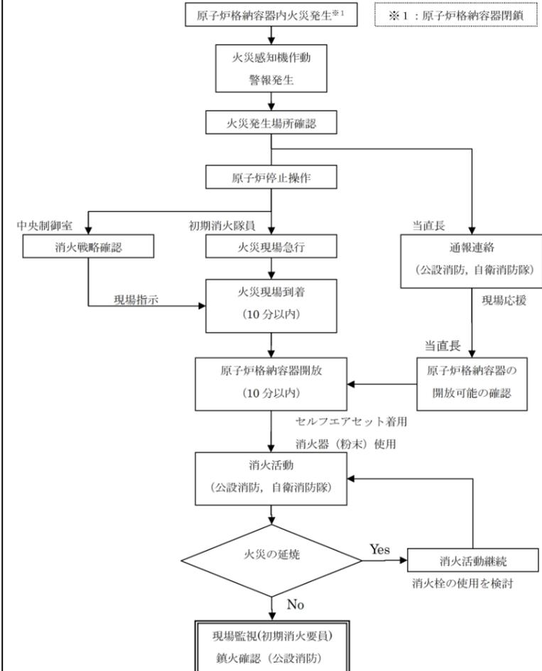
第 8-9 図 原子炉格納容器内での火災発生に対する対応フロー
