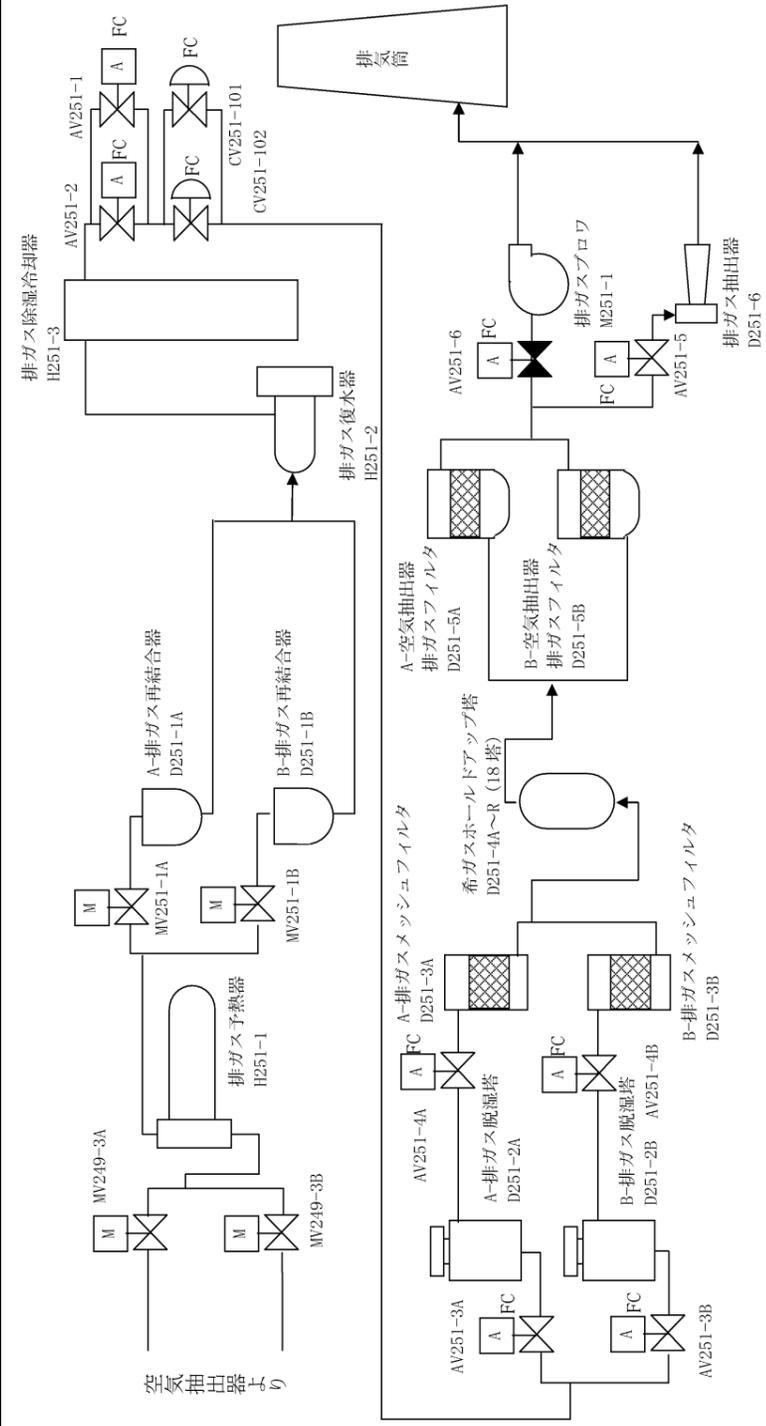
第 9-1 図 気体廃棄物処理系 系統概要図
