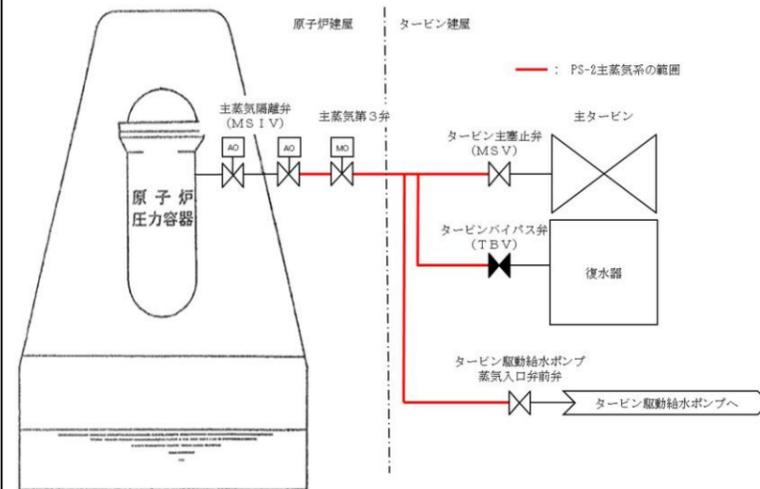
第9-15図 主蒸気系 系統概略図
