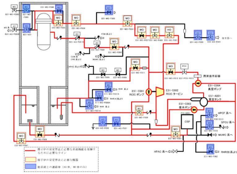
第8-22図 原子炉隔離時冷却系
