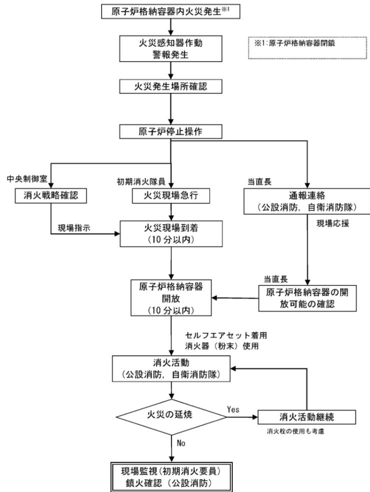
第 8-12 図 原子炉格納容器内での火災発生に対する対応フロー
