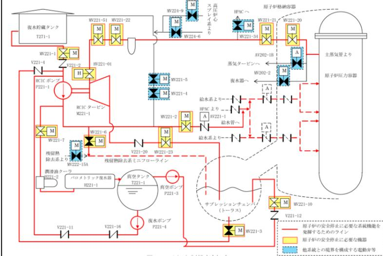
第8-17図 原子炉隔離時冷却系
