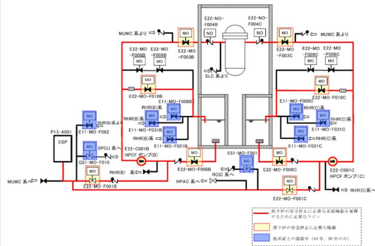
第8-21図 高圧炉心注水系
